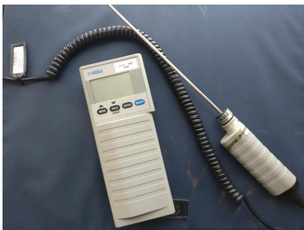
Bild 10. Fuktmätaren som användes var en Vaisala HM141. (Eget foto) Bild 9. En pågående fuktmätning. (Eget foto)
