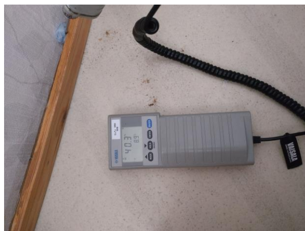
Bild 10. Fuktmätaren som användes var en Vaisala HM141. (Eget foto) Bild 9. En pågående fuktmätning. (Eget foto)
