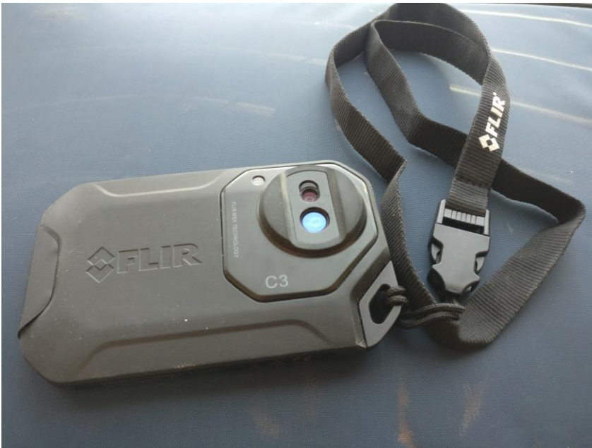
Bild 16. Värmekameran som blev använd, FLIR C3. (Eget foto)
