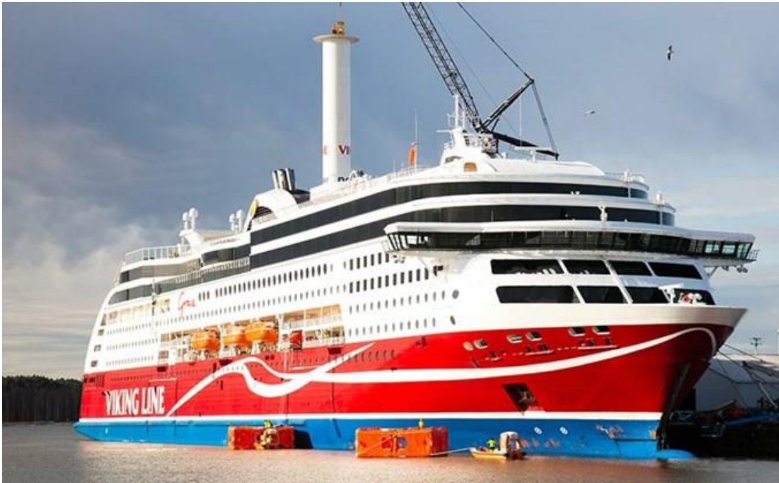
Figur 4 Viking Grace med rotorseglet vid installation (Viking Line)
