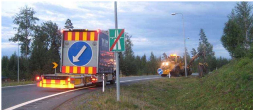
Kuva 5. Törmäysvaimentimella (TMA) varustettu suoja-ajoneuvo (Liikennevirasto, 2018b, s. 42).
