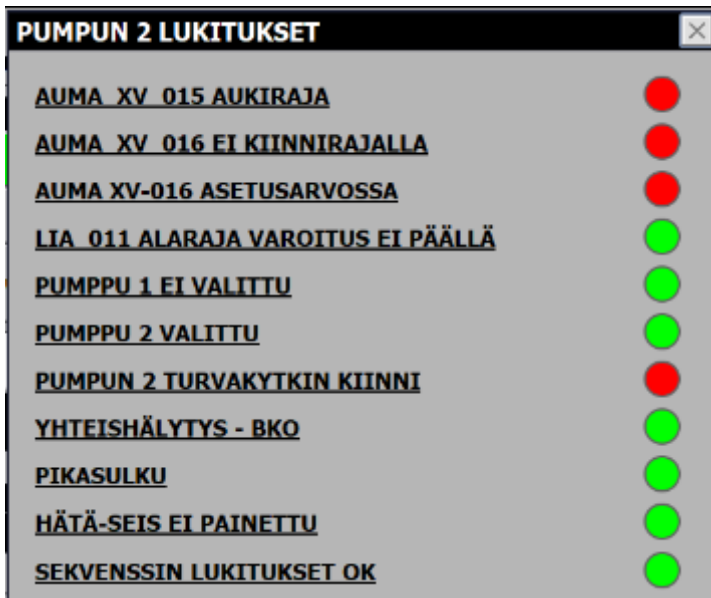
KUVA 37. Pumpun 2 lukitus -ponnahdusikkuna
