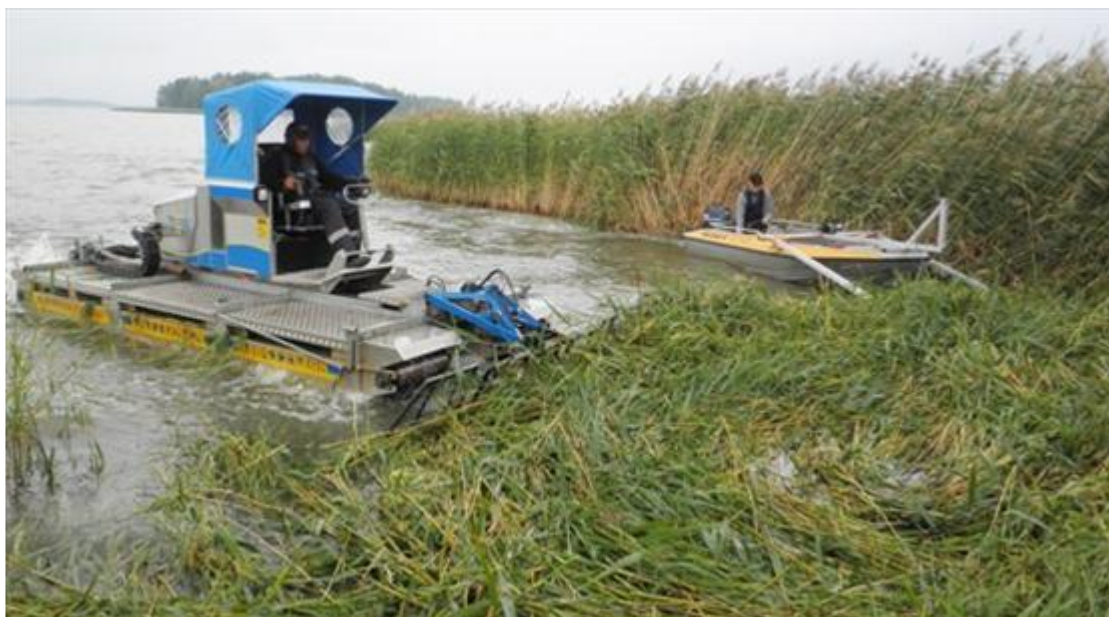
Kuva 8. Vesikasvuston niittämistä Truxor-mallisella lautalla (Ruovikon vesileikkuu 2014).
