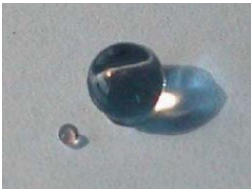
Kuva 25. Kuiva ja paisunut SAP-kuula. /44/
