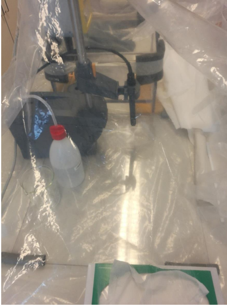
Kuva 2. Johtokyky mittari ja mittaukseen tarvittavat välineet tyypiteltan sisällä
