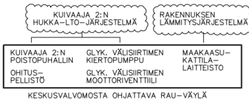
Kuva 18. Periaatekuva kuivaaja 2:n hukka-LTO-järjestelmäkokonaisuudesta muutostilanteessa.
