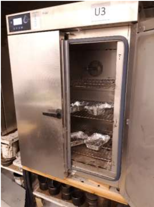
KUVA 9. Proctor-kokeen näytteet kuivumassa uunissa
