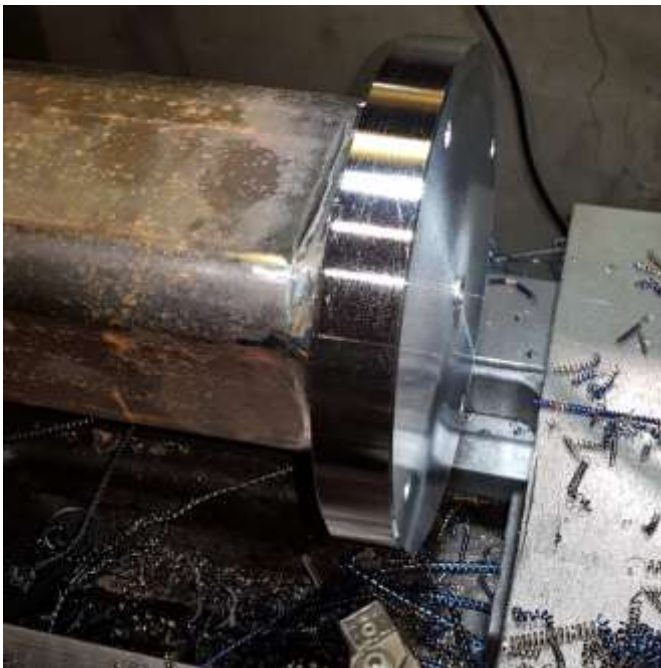
KUVA 22. Robotin jalusta, laippa sorvattu suoraksi hitsaamisen jälkeen
