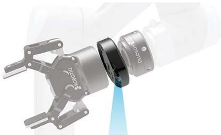
KUVA 12. Rannekamera tarttujan ja työkalulaipan välissä (10)
