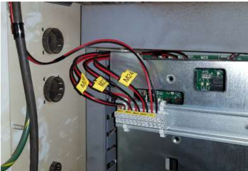
KUVA 18. M-releet ja Cycle Start kytkettynä riviliittimiin
