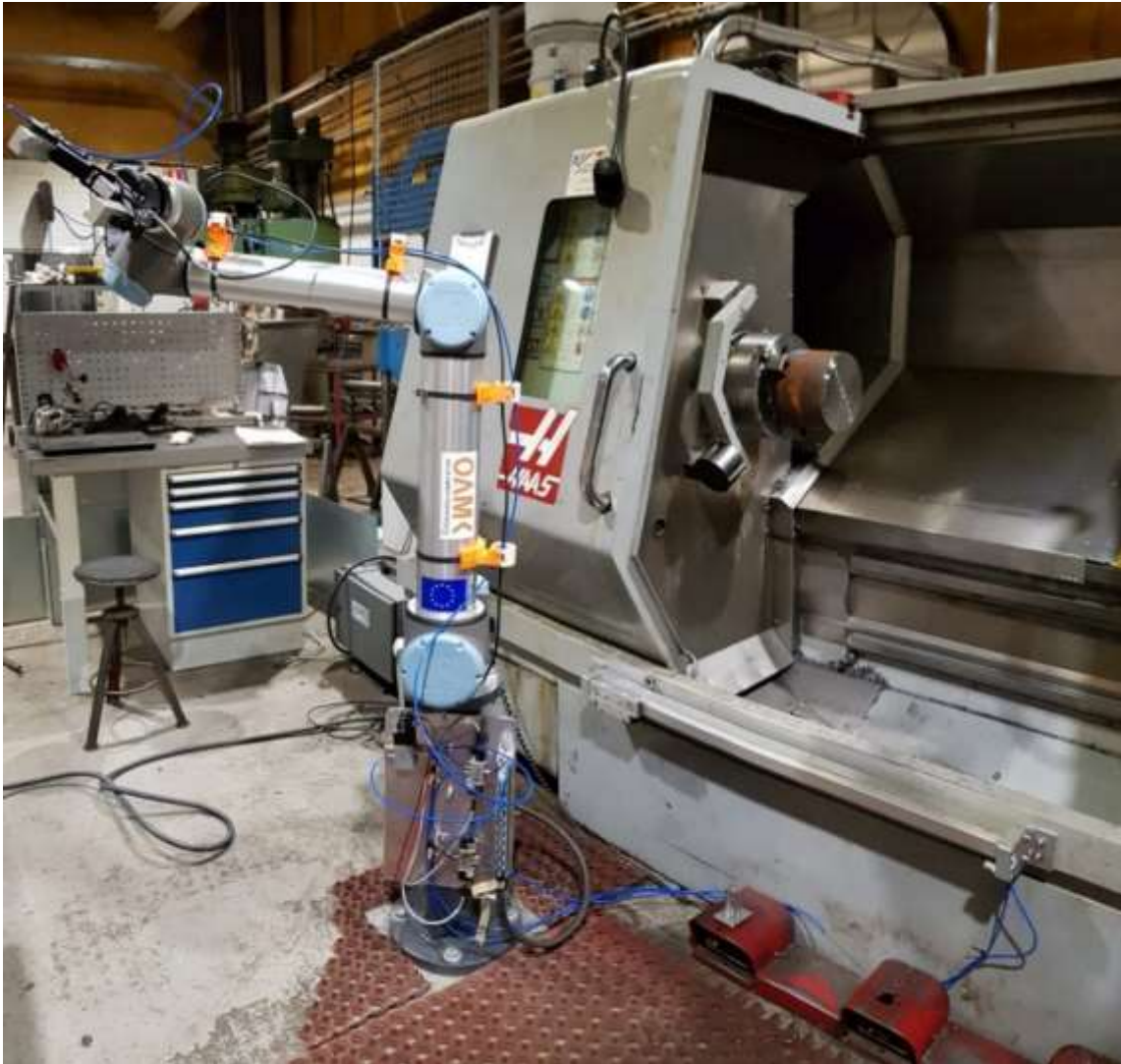
KUVA 23. Robotti jalustallaan, sylinterit ja pneumatiikkataulu
