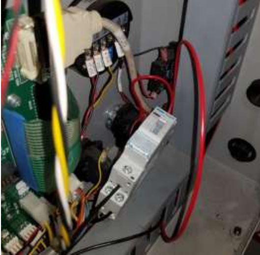
KUVA 17. Cycle Start -rele kytkettynä
