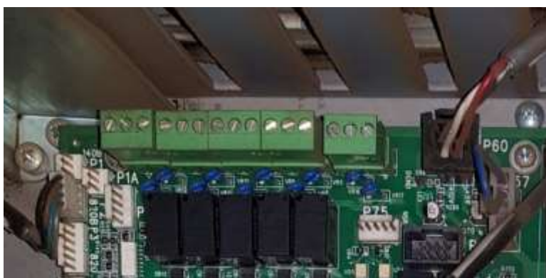
KUVA 8. M-releet, mustat ovat releitä ja vihreät niiden riviliittimet
