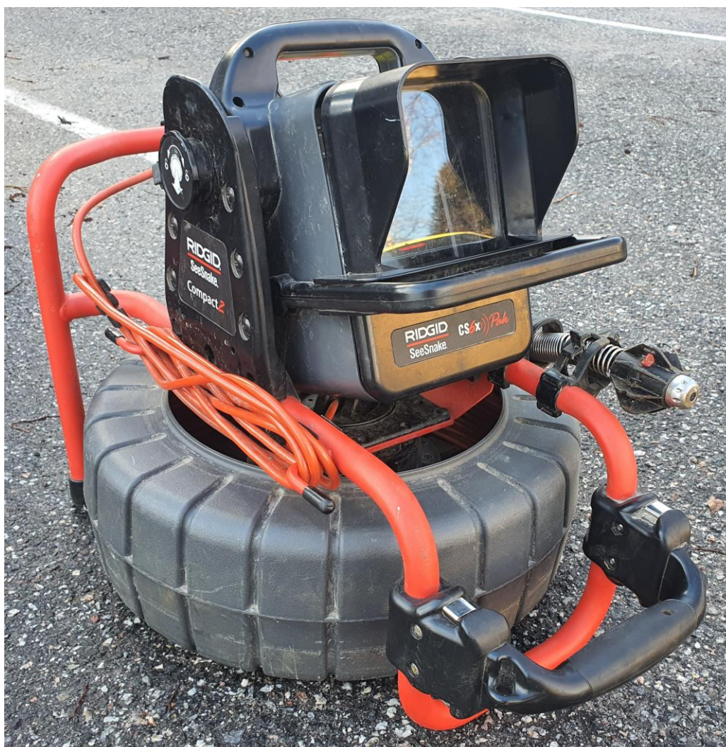
Kuva 18. Ridgid SeeSnake Compact2 -kamerakela ja Ridgid CS6Pak -monitori [8]
