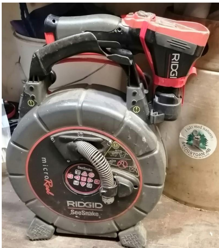
Kuva 17. Pystymallinen Ridgid SeeSnake microReel mallinen -putkistokamera [8]
