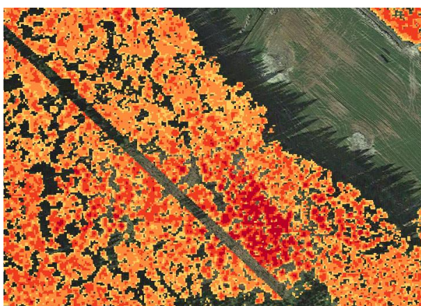
Kuva 1. Lisensittömällä LAsTools-ohjelmistolla luotu CHM, jossa on havaittavissa pikselitön juova.
