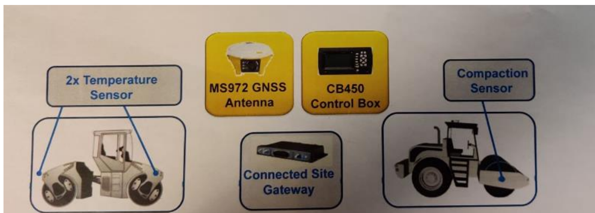
KUVA 5 Jyrän koneohjausjärjestelmän komponentit [5]
