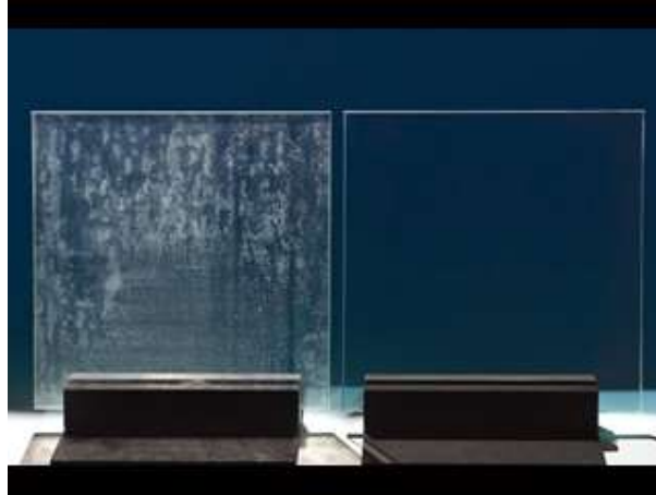
Kuva 18. Vertailuanalyysi, jossa vanhemmistestein korkeissa lämpötiloissa ja kosteudessa osoitetaan, että pinnoitteella voidaan rajoittaa korroosioprosessia ja kalkkisaostumia verrattuna käsittelemättömään lasiin (Pilkington 2020d).
