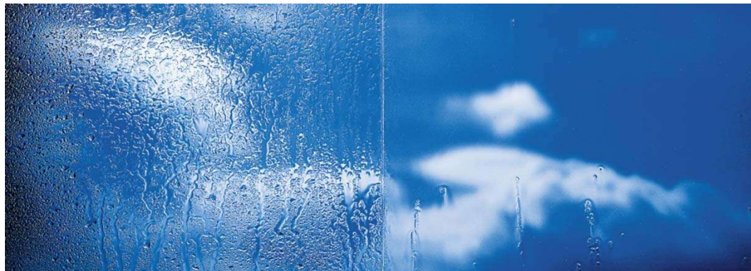
Kuva 17. Puhdistustarvetta vähentävä pinnoite toimii auringon UV-säteilyn ja veden yhteisvaikutuksesta. Se myös ylläpitää näkyvyyttä ulos sateen aikana eikä huuru niin helpolla kuin pinnoittamaton lasi. Kuvassa vasemmalla pinnoittamaton lasi ja oikealla pinnoitettu. (Saint-Gobain.)
