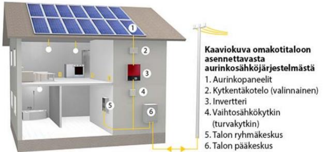
Kuva 16 Turvakytkimen sisältävä aurinkopaneelijärjestelmä. (Kuopion Sähköverkko Oy, 2015)
