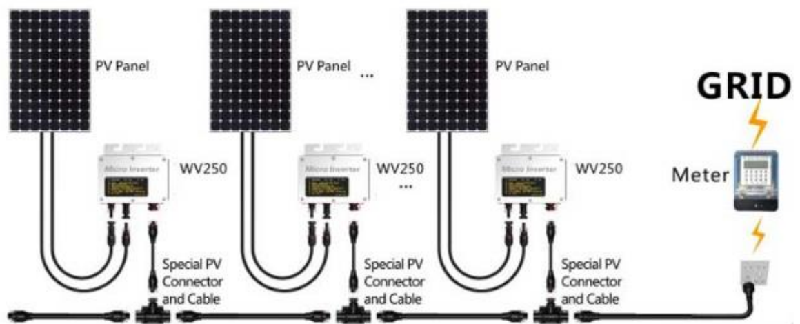
Kuva 12 Mikroinvertterin liittäminen aurinkosähköjärjestelmään. (Electrotori, 2020)
