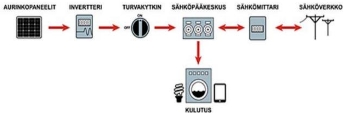
Kuva 17 Aurinkopaneelijärjestelmän havainnollistaminen. (Kuopion Sähköverkko Oy, 2015)
