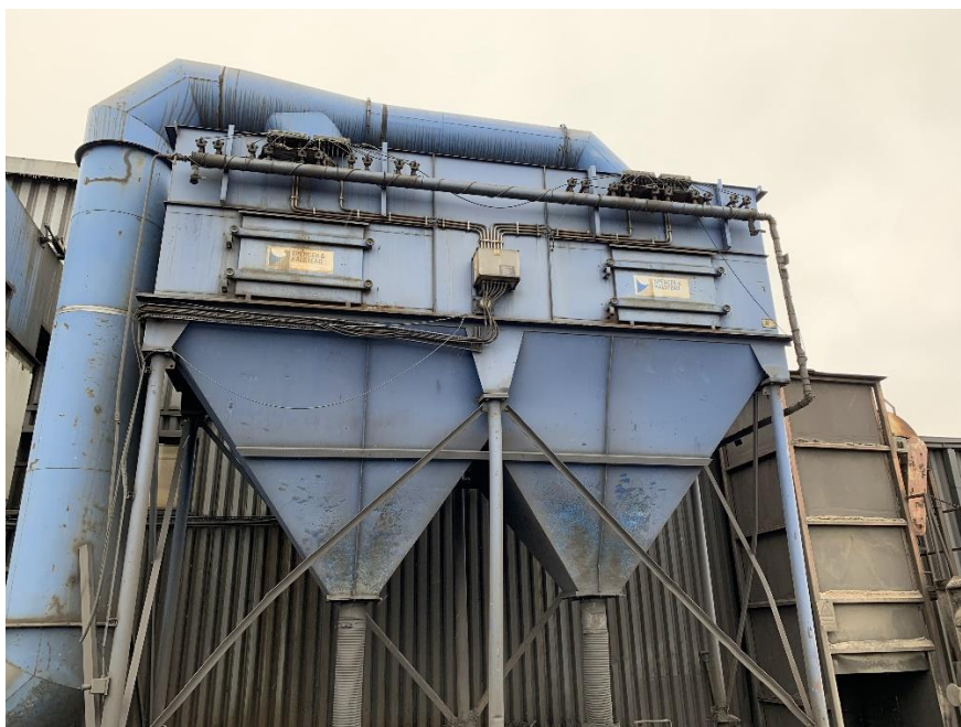
Kuva 14. Pölykammio, missä on kaikista hienoin metallipöly. (Otra-aho, 2020)
