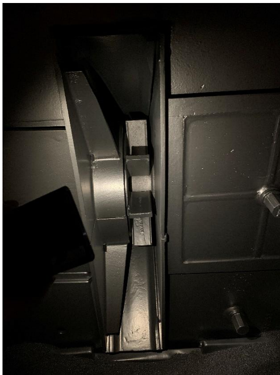
Kuva 4. Sinkopyörä puhalluskammiossa. (Otra-aho, 2020)
