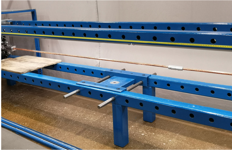
Kuva 14. Alumiiniruuveilla kiristetty liitin vetokokeessa.
