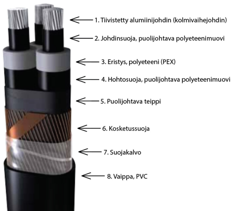
Kuva 3. AHXCMK-WTC keskijännitemaakaapeli [15, s. 4].
