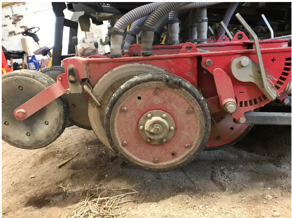
Kuva 7. VM 6000DS kaksoiskiekkovannasyksikkö, jossa näkyy kylvösyvyyden määrittävä sivupyörä ja perässä kulkeva peittopyörä.
