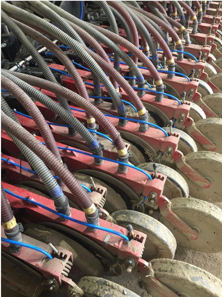
Kuva 18. Pneumatiikkaletkut vedettynä vantaan taakse.
