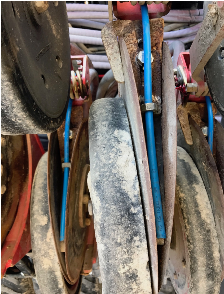
Kuva 19. M8- mutteri hitsattuna vannasraappaan ja nesteletku vedettyä vantaan alaosaan.
