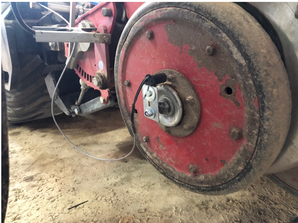
Kuva 22. Pulssianturi asennusvaiheessa vielä ilman suojakoteloä.
