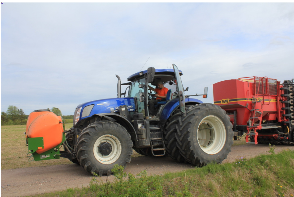
Kuva 11. Amazone FT 1001-etusäiliö kylvötraktorin keulalla.
