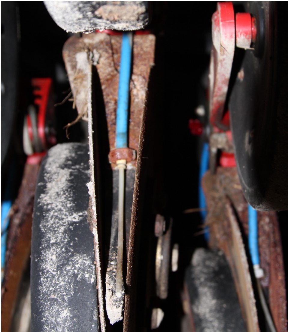
Kuva 20. Toimivampi versio nestelinjalle ohuemmallalla pneumaletkulla.
