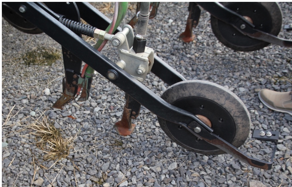
Kuva 5. Suorakylvökoneen vannas, jossa näkyy nestelinja, siemenlinja ja rakeinen vannaslinja.
