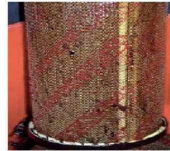
Suodattimien tukkeutuminen (plugging?)
