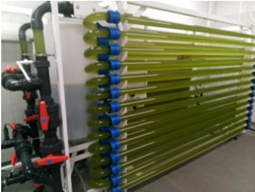
Kuva 2: Helsingin yliopiston fotobioreaktori (Varicon Aqua) (Helsingin yliopisto)
