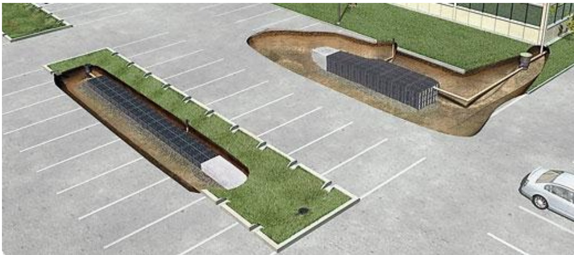
Kuva 8. Hulevesikaseteilla täytetty imeytyskaivanto
