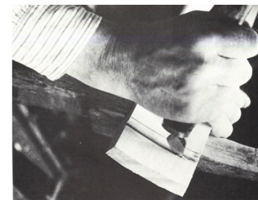
Kuva 13. Uurteen veistoa uurrinpuukolla. (Vilkuna & Mäkinen 1976, 285).
