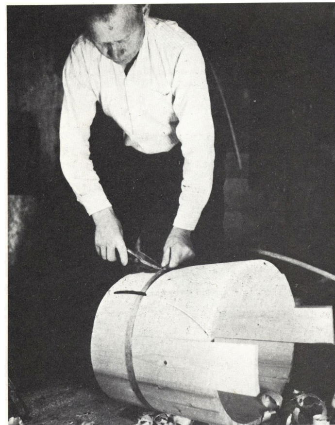
Kuva 11. Metallivanteen kiinnittäminen niiteillä kehäksi. (Vilkuna & Mäkinen 1976, 286.)
