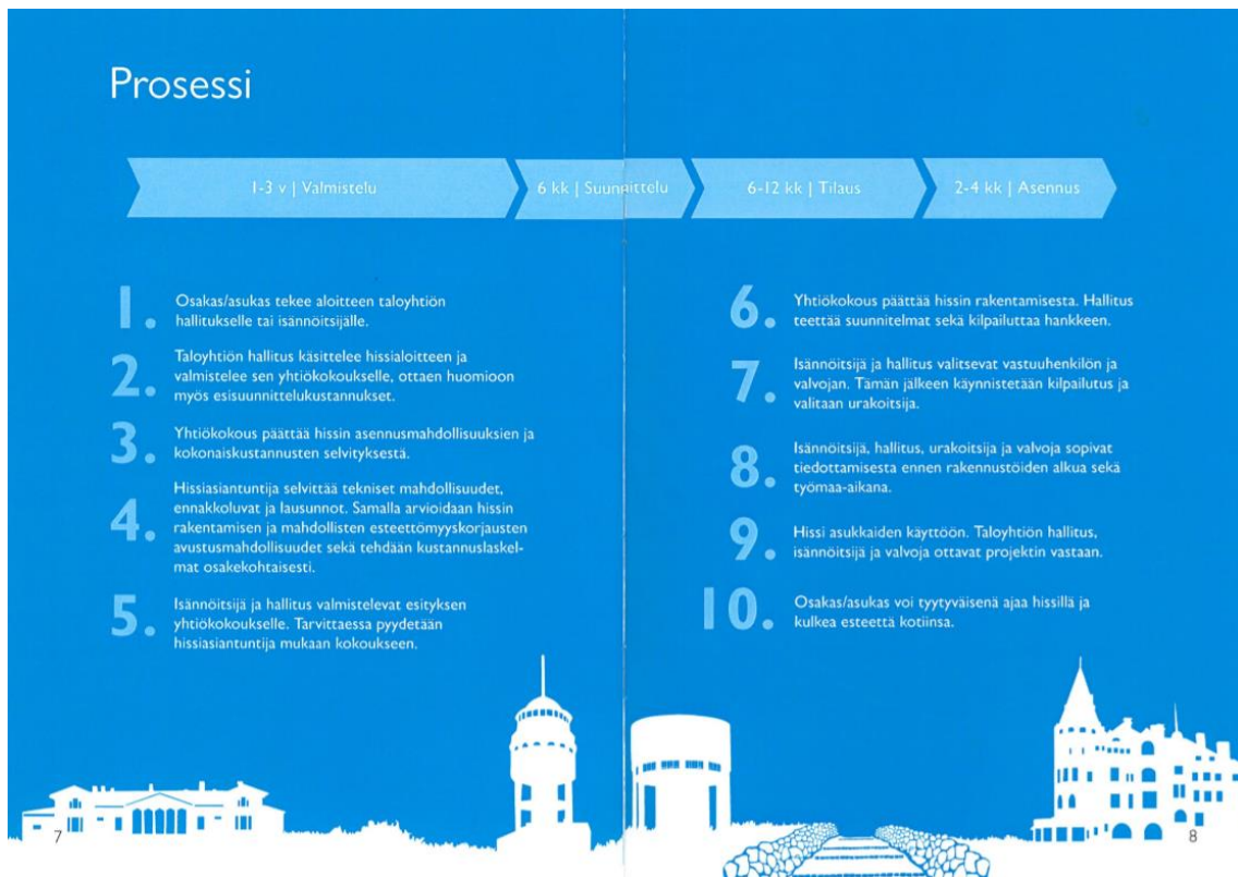
KUVA 3. Jälkiasennushissin prosessikuvaus (13, s. 7-8)
