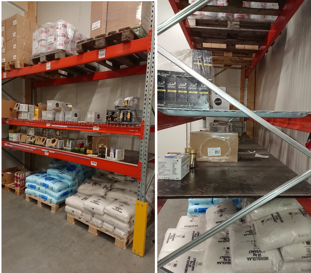
Kuva 16 ja 17. Myös näissä kuvissa tilanteissa on kuormalavahyllyä käytetty pientavarahyllyn asemasta. Hyllyssä on paljon tyhjää tilaa korkeus- ja syvyyssuunnissa sekä alimman tason keräysergonomia on todella huono.
