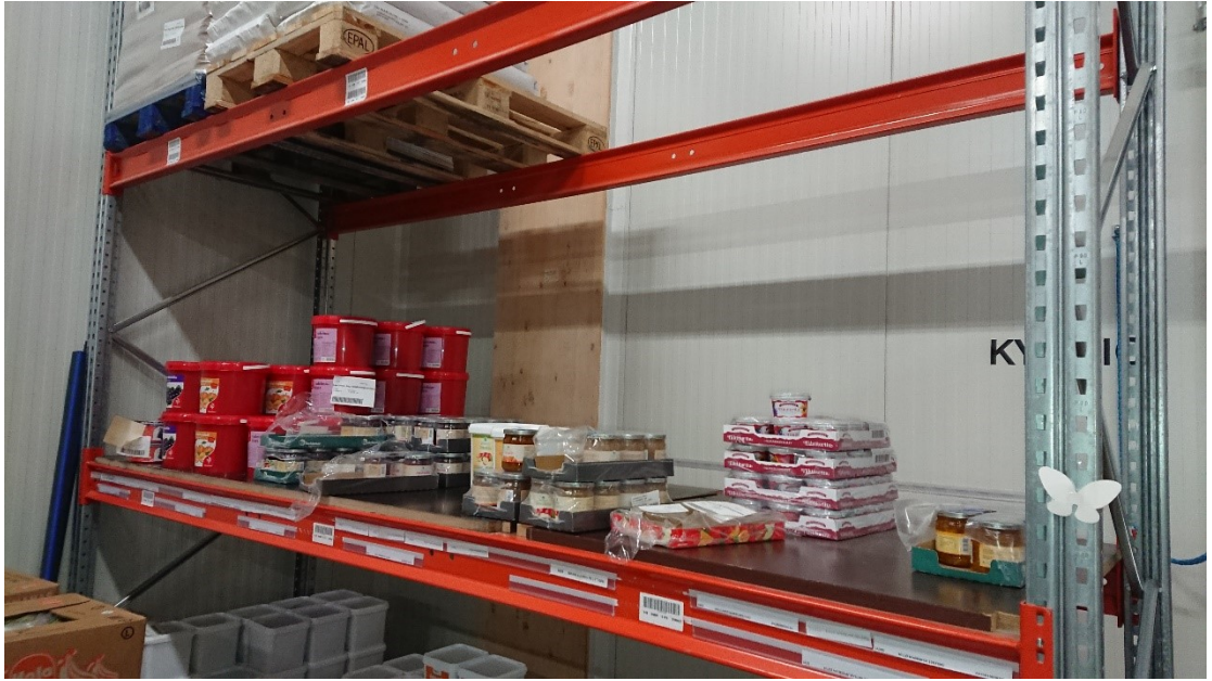
Kuva 13: Kuormalavahyllyä on käytetty pientavarahyllyn asemasta. Hyllyssä on paljon tyhjää tilaa niin korkeus, kuin syvyysuunnassa. Fyysiseltä kooltaan pienien tuotteiden, kuten kuvan hillopurkkien, varastointi kuormalavahyllyssä ei ole järkevää.
