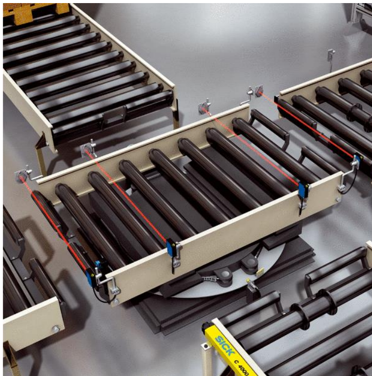
Kuva 5. Kääntöpöydällä tarkoitetaan tässä työssä kuljetinta, jota voidaan tilanteen mukaan ohjata kääntymään eri asentoihin tavaran vastaanottoa ja lähettämistä varten (SICK).
