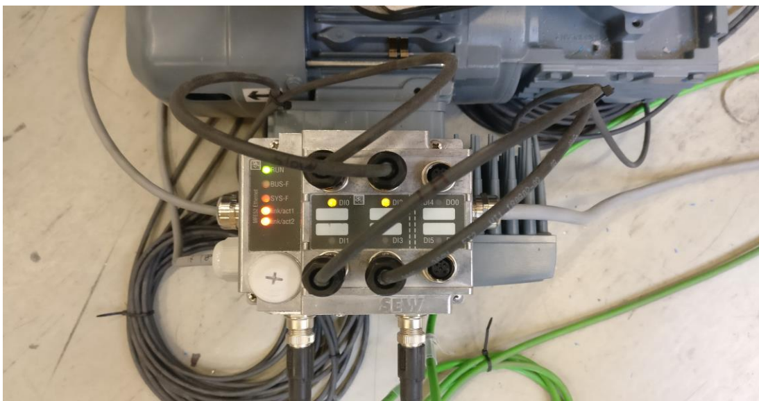
Kuva 3. Tulot ja lähdöt kulkevat SEW Movimotissa teknologiayksikön kautta
