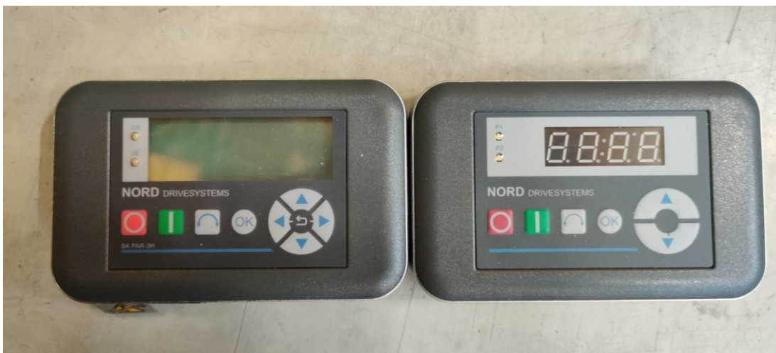
Kuva 10. SK PAR-3H ja SK CSX-3H parametrinti- ja hallintayksiköt.
