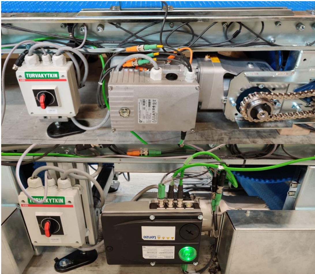
Kuva 11. Nordac SK180 (yllä) ja Lenze Motec 8400 (alla) moottoreineen asennettuna kuljettimiin
