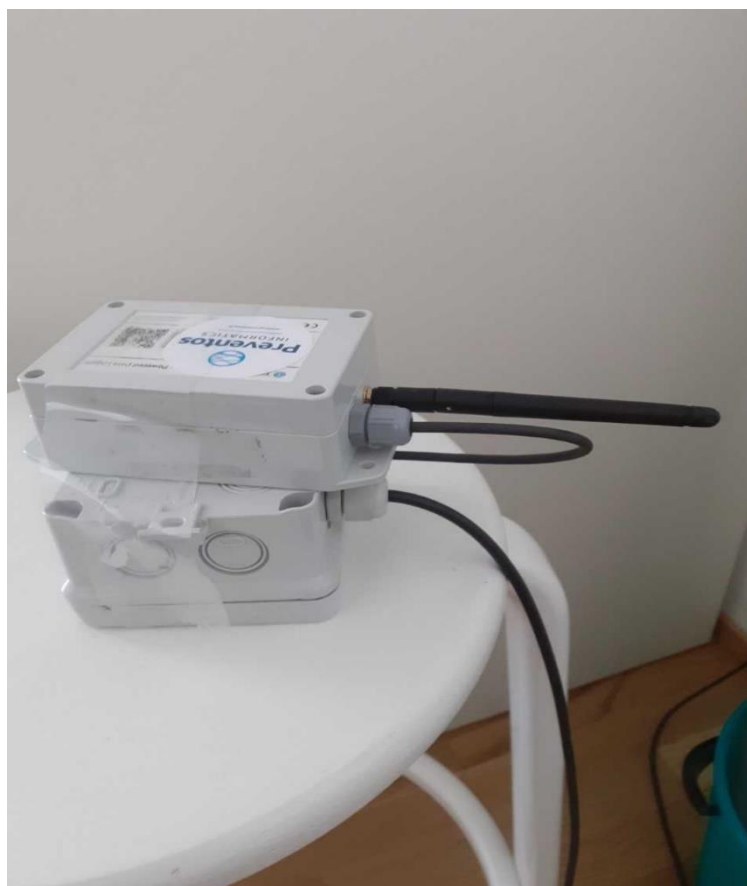
Kuva 3. Tiedonsiirtolaite ja painesensorin virtalähde. (Suhonen, Ville 2020)
