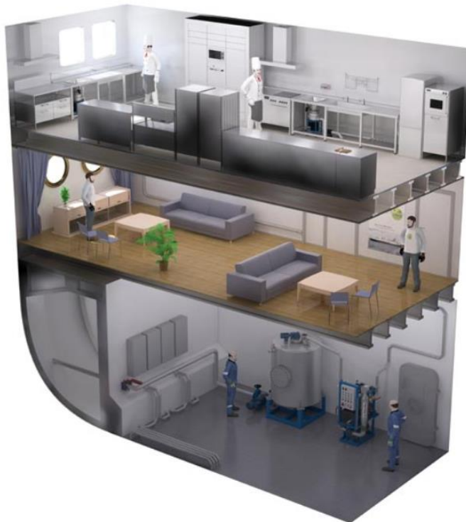
Kuva 15. Evacin ruokajätteen alipainekeräysjärjestelmä (Evac food waste management system s.a)
