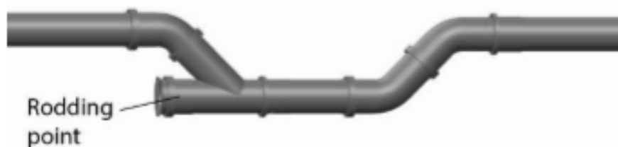
Kuva 12. Huoltoluukut on suositeltavaa sijoittaa kuljetustaskun yhteyteen (Evac 2019, 13)
