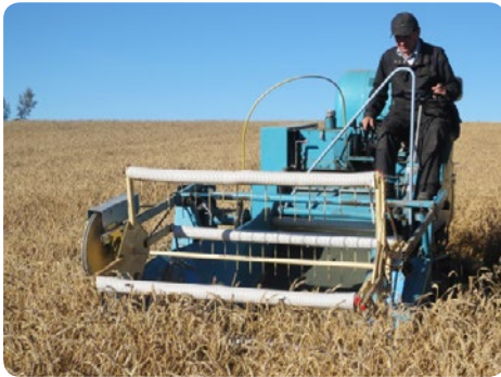
Kuva 7. Koealokojen puinti koeruutupuimurilla.
