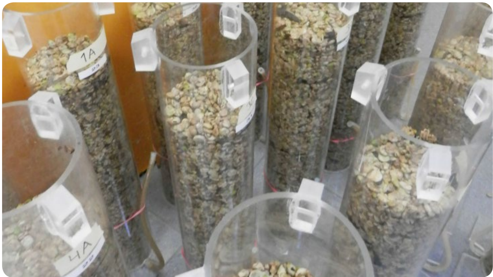
Kuva 1. Murskatut pavut tiivistettynä koesiiloihin ennen siiloen sulkemista. Kuva: Marketta Rinne, Luke.
