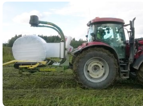
Kuva 11. Härkähäpäsäilörehun käärintä muoviin. Kuva: Katriina Manni, HAMK.
