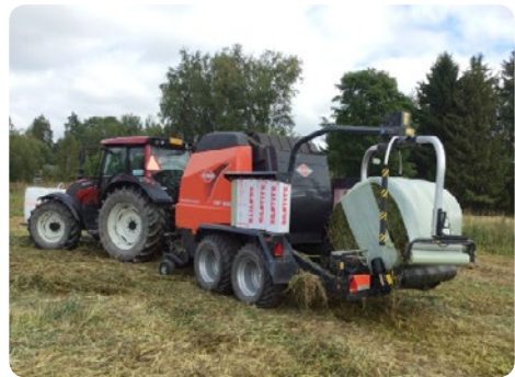
Kuva 8. Käärintä tehtiin välittömästi paalauksen jälkeen. Kuva: Katriina Manni, HAMK.
