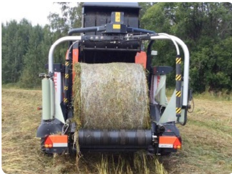
Kuva 7. Paalaus ja verkkosidonta. Kuva: Katriina Manni, HAMK.
