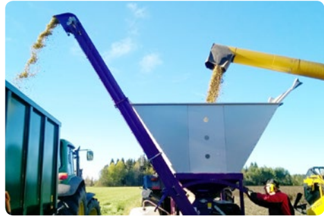
Kuva 3. Papujen murskaus käynnissä. Kuva: Kaisa Kuoppala, Luke.
