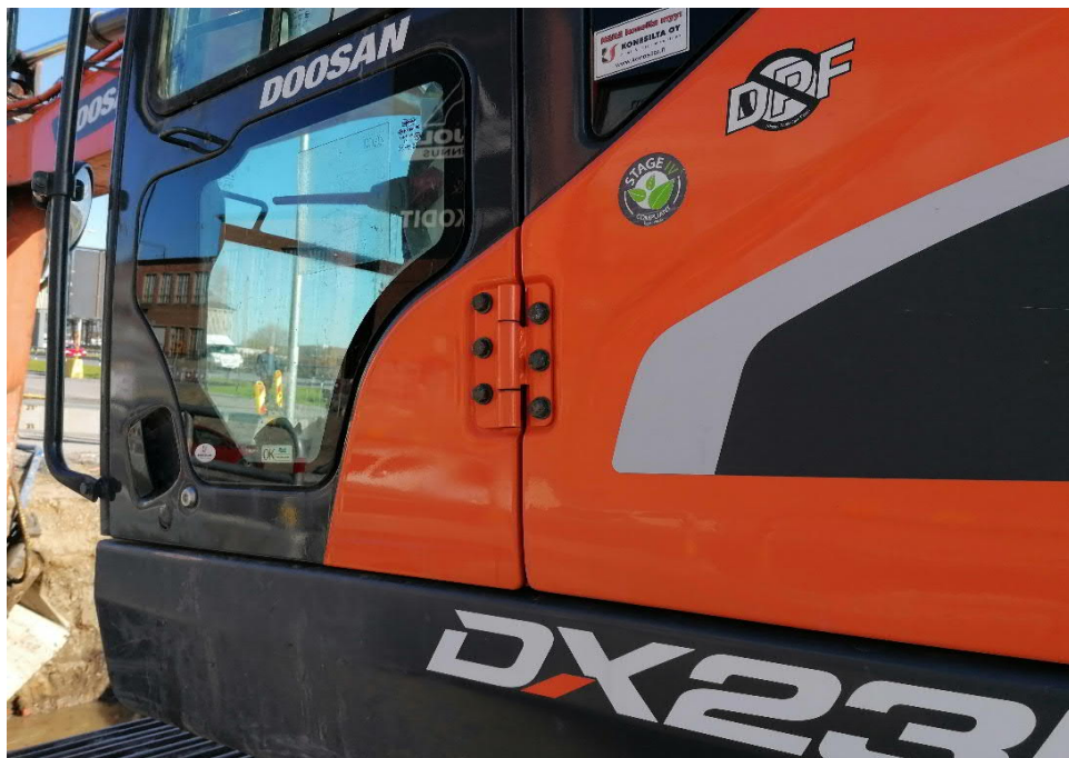
Kuva 8. Erään urakoitsijan kaivinkoneen kyljessä oleva merkintä, joka kertoo koneen päästoluokasta (kuva: Salmela, 2020).
