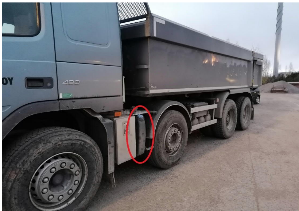
Kuva 9. Typenoksidipäästöjen vähentämiseksi ajoneuvoihin ja työkoneisiin on usein asennettu SCR-jälkikäsittelylaitteisto. Kuvassa ympyröity sälliö sisältää laitteistossa käytettävää AdBlue-urealiuosta (kuva: Salmela, 2020).
