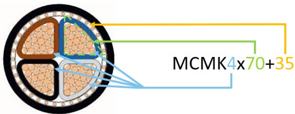
KUVA 22. MCMK -kaapelin poikkileikkaus
