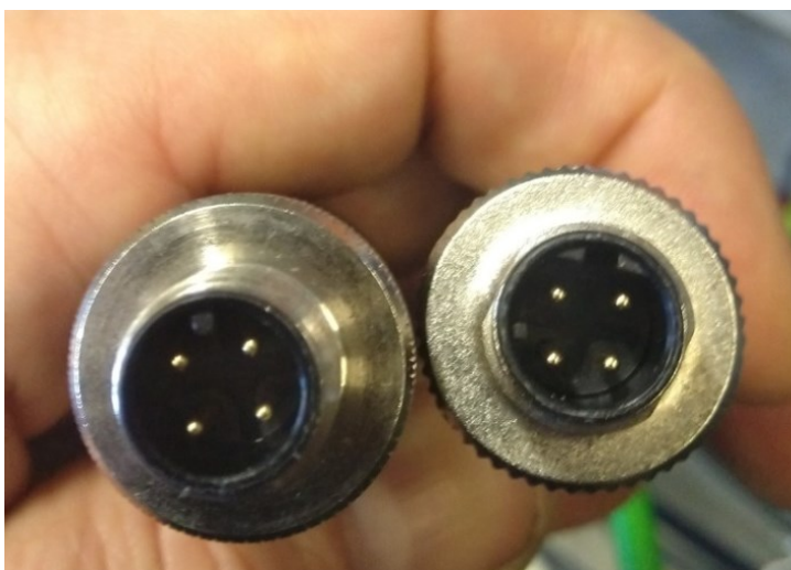
KUVA 15. M12-A tyyppin liitin vasemmalla ja oikealla M12-D tyyppin liitin.
