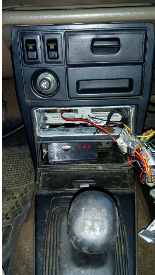
Kuva 11. MegaSquirt:n sijainti keskikonsolissa.
