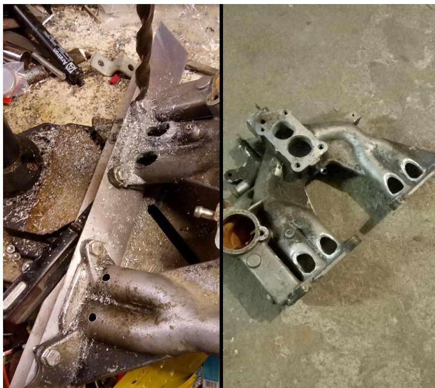
Kuva 7. Suuttimien reiät porauksen aikana ja jälkeinpäin hiottuina.
