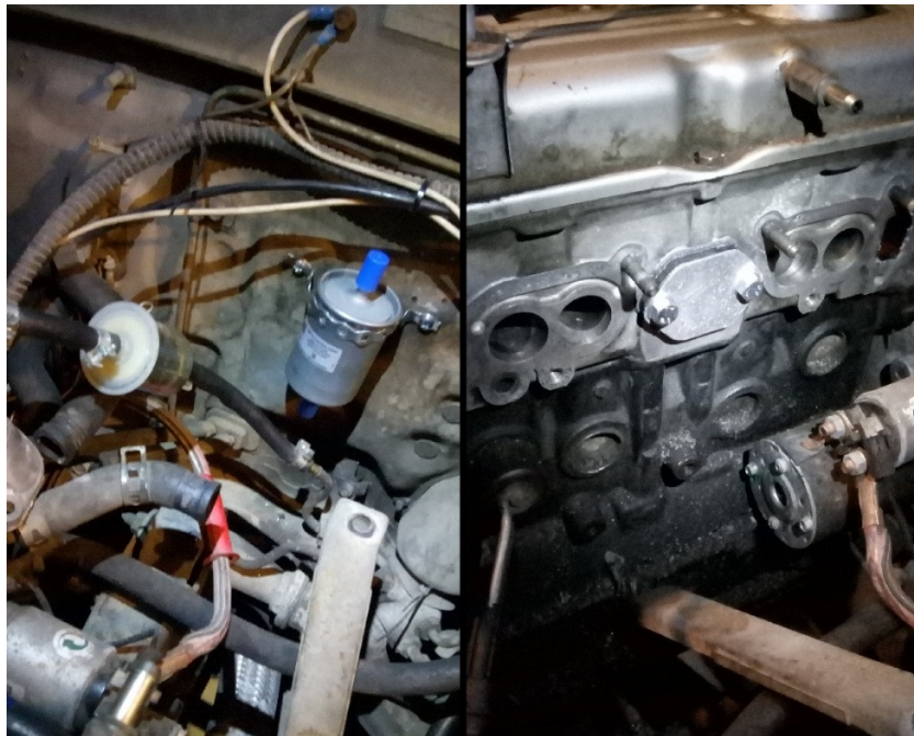
Kuva 10. Polttoainesuodattimen asennus sekä vanhan polttoainepumpun peitelevy.
