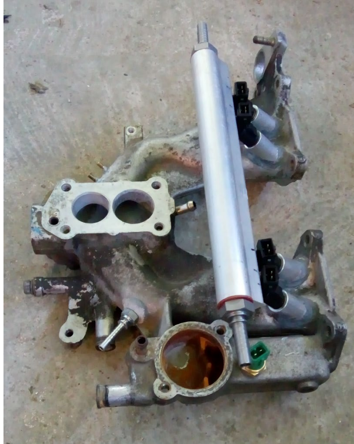
Kuva 12. Valmis imusarja suuttimilla ja jakoputkella.
