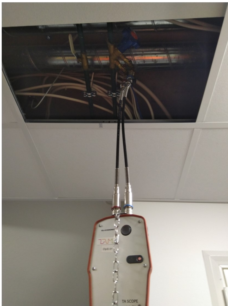
KUVA 6. Paine-ero lähetin liitettynä linjasäätöventtiiliin.
