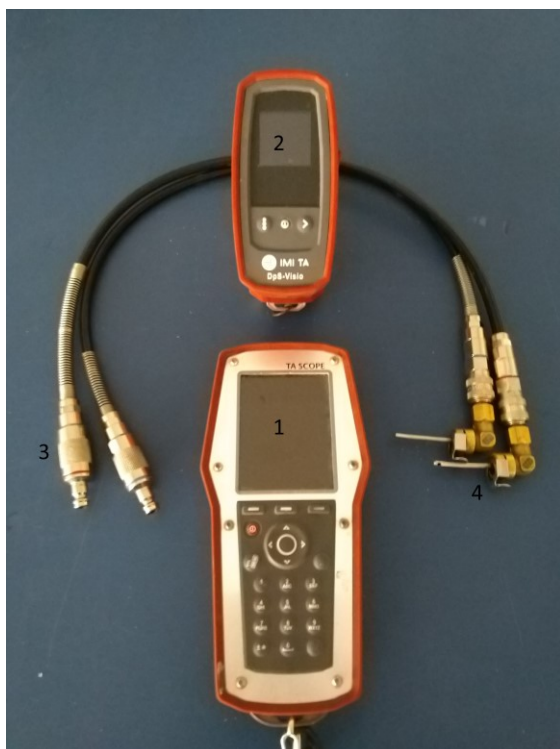
KUVA 4. 1) TA Scope paine-ero mittari, 2) paine-ero lähetin, 3) mittaletkut ja 4) mittaneulat.
