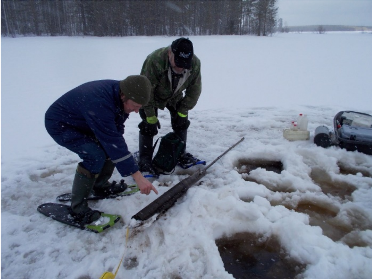
Kuva 20. Väinö Vornanen (vas.) ja Keijo Silfsten tutkivat turvekairalla otettua Korpijärven pohjasedimenttinäytettä 22.03.2019. Kuva: Tarmo Tossavainen.
