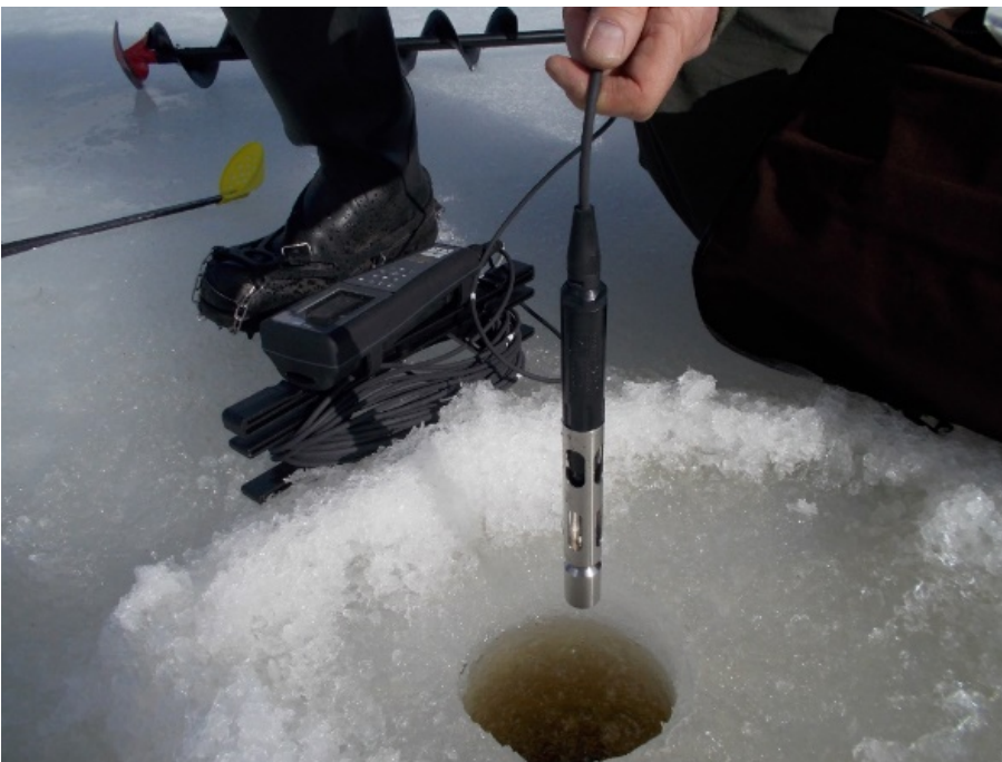
Kuva 17. Tarmo Tossavainen laskee YSI ODO -happikenttämittarin optista elektroodia Korpijärveen 30.03.2020. Kuva: Väinö Vornanen.
