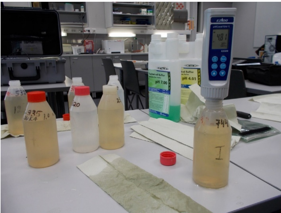
Kuva 19. Korpjärven vesinäytteen pH-mittaus EZDO 8200-mittarilla Karelia-ammattikorkeakoulun laboratoriossa 31.03.2020. Tällä mitattiin myös veden sähkönjohtavuus. Kuva: Tarmo Tossavainen.
