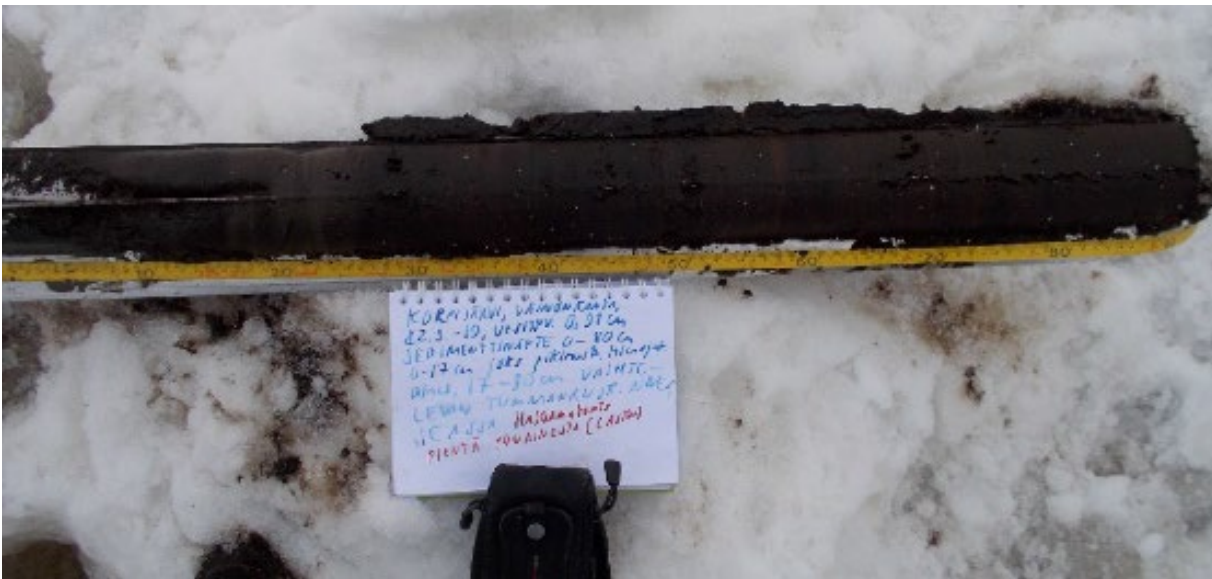
Kuva 22. Korpijärven havaintopaikan "Väinönranta" pohjasedimenttinäyte 22.03.2019.
