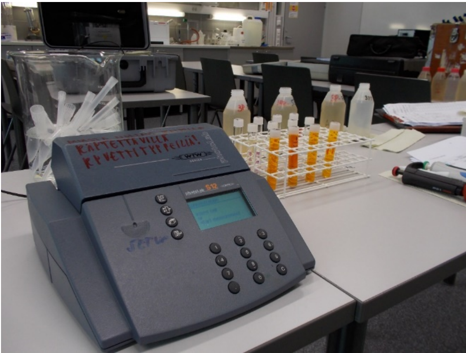
Kuva 18. Korpjärven vesinäytteen raskasmetallien mittausta WTW S 12 A-filtterifotometrillä valmistellaan Karelia-ammattikorkeakoulun laboratoriossa 31.03.2020. Kuva: Tarmo Tossavainen.
