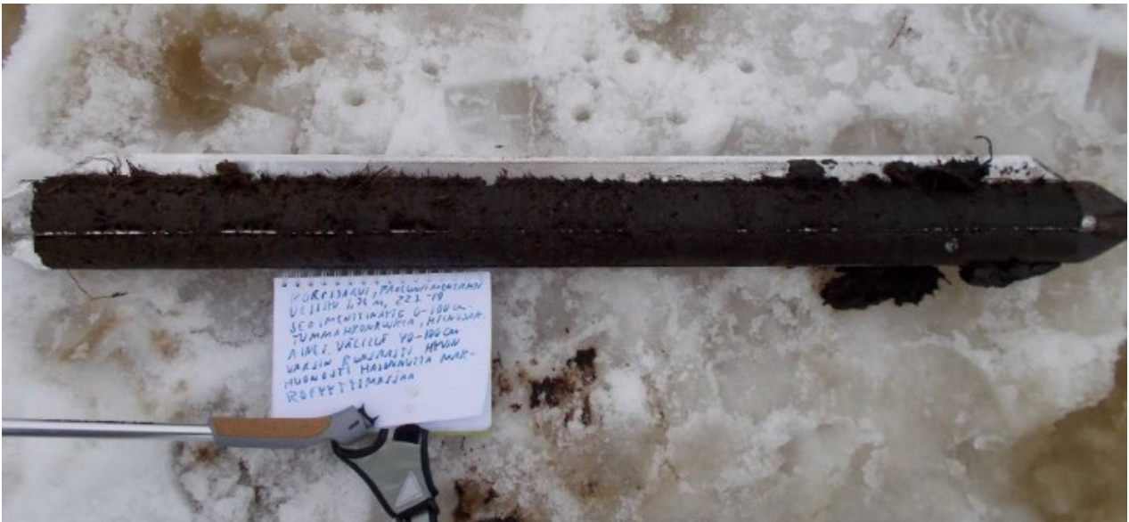
Kuva 23. Korpijärven havaintopaikan "Paaluniemenranta" pohjasedimenttinäyte 0-100 cm 22.03.2019.
