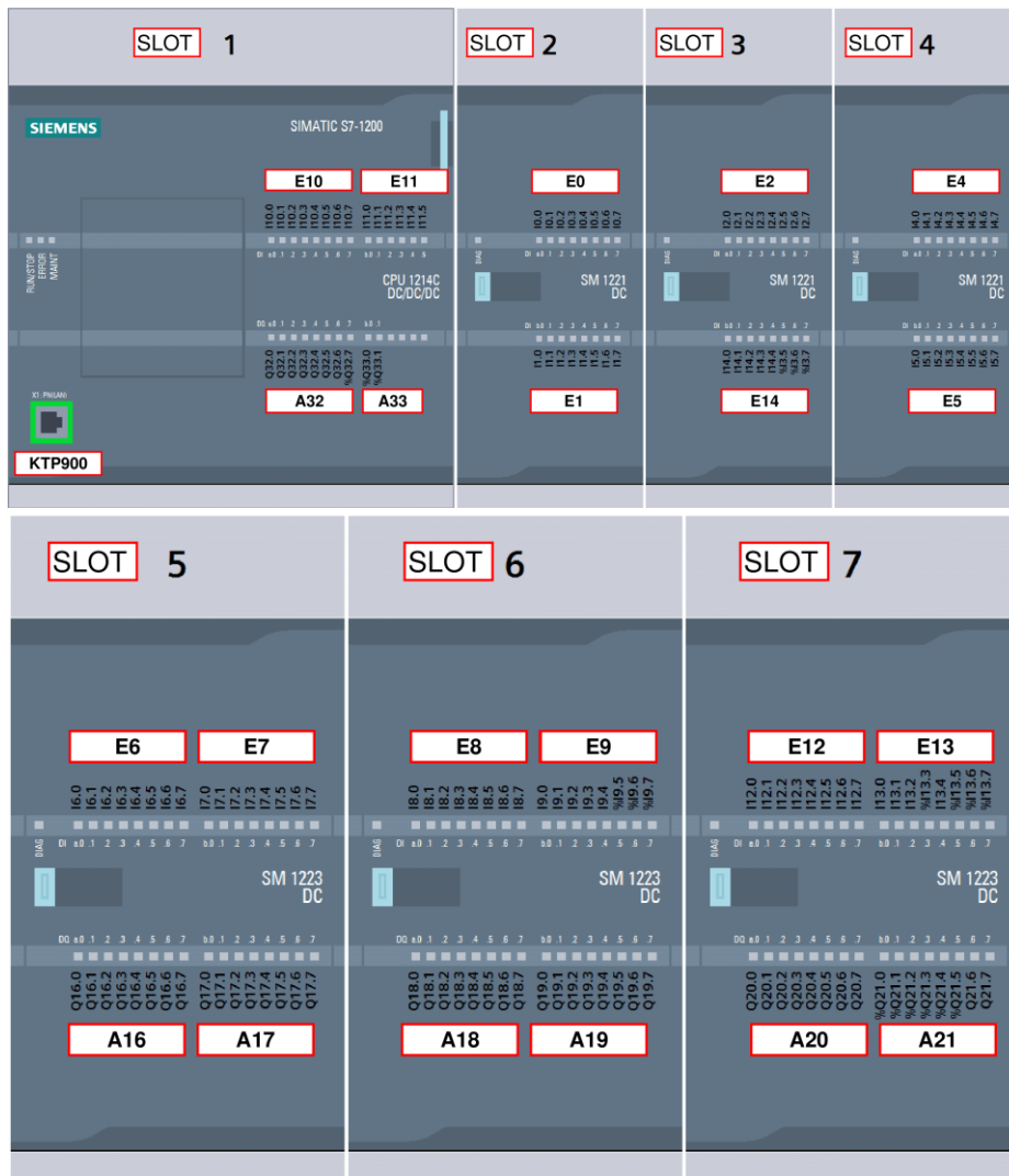
KUVA 21. Tuleva I/O-jaottelu uudelle konfiguraatiolle
