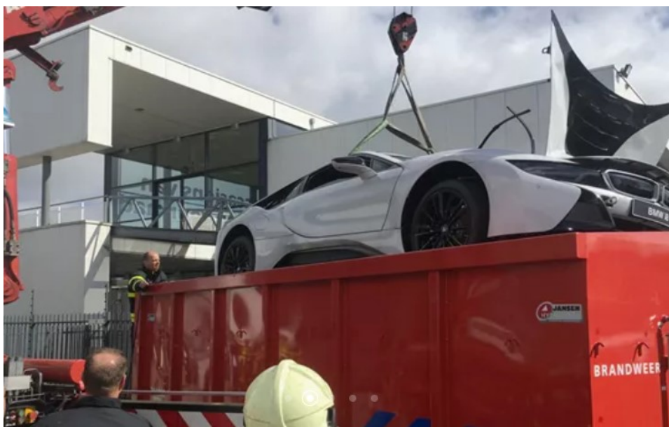
Kuva 14. BMW i8 –sähköauton siirto sammutuskonttiin. (Brandweer Nederland, 2019)
