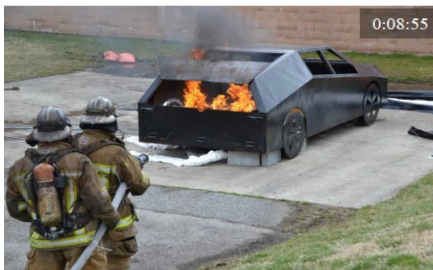
Kuva 16. Kuva Yhdysvalloissa tehdystä polttokokeesta (Blum ym., 2013, s. 104)
