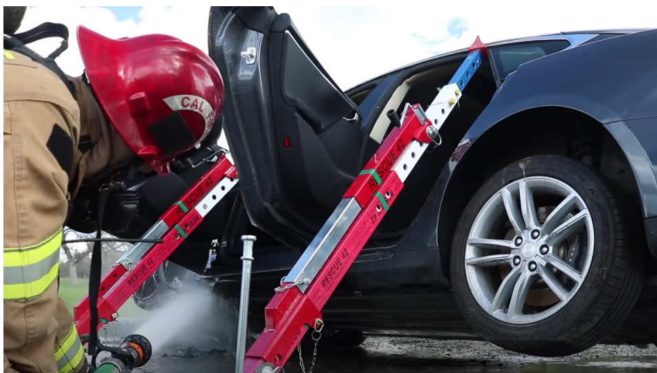
Kuva 17. Auton kallistaminen tehokkaan jäähdytyksen mahdollistamiseksi (Archer, 2019)
