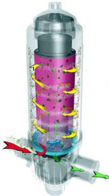
Kuva 28 Suodattimen toiminta normaalitilanteessa (Hirvonen 2020a.)
