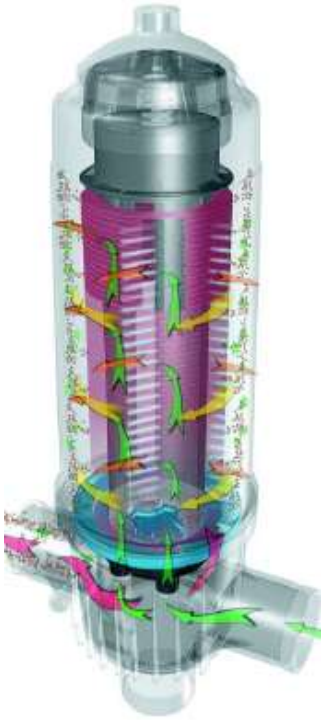
Kuva 29. Suodattimen toiminta vastahuuhtelujakson aikana (Hirvonen 2020a.)
