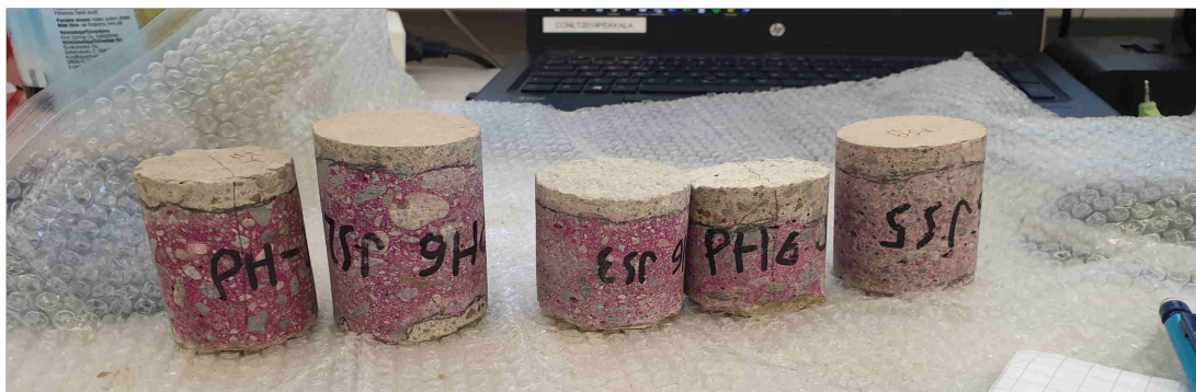
Kuva 17. Kevyen lisäkuntotutkimuksen yhteydessä julkisivuista otetut betoninäytteet. Kuva: Arja Pekkala 2019.
