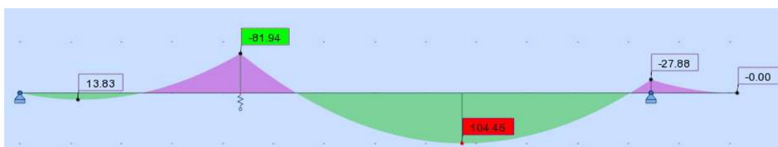
Kuva 27. Tapaus 2. Murtorajatilan kuorma. Kuormayhdistelmä 1,15 \times DL1 + 1,5 \times LL1 .
