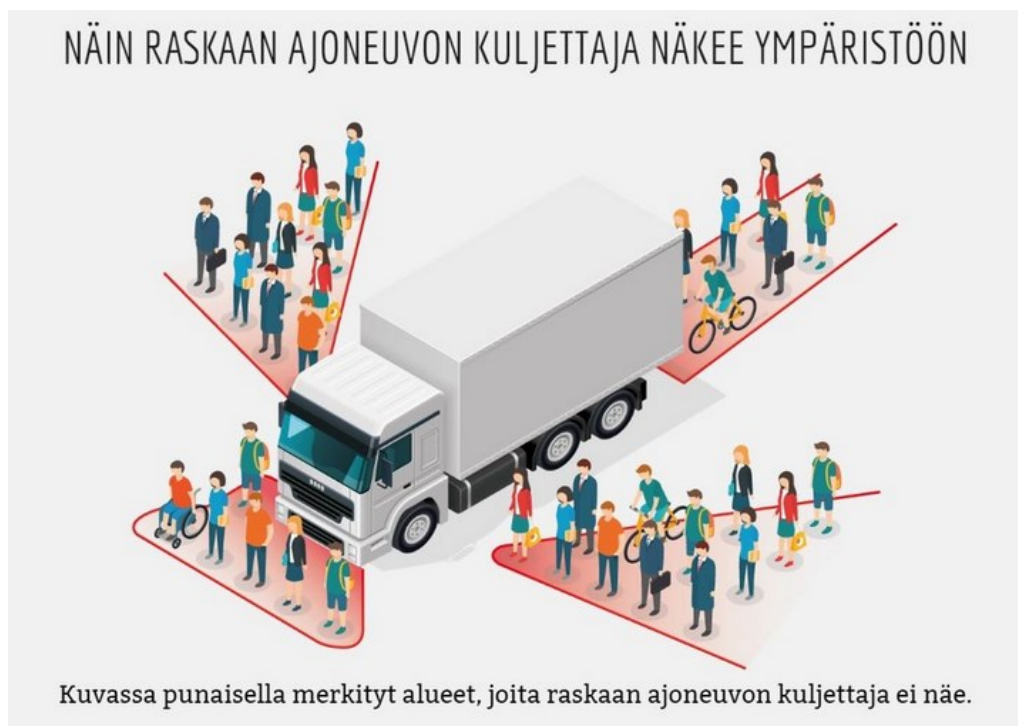
Kuva 50. Raskaan kaluston kuljettajalla on paljon katvealueita. (Katveturva Oy, 2020)
