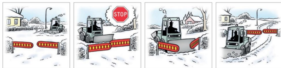
Kuva 30. Käännettävällä sulkupuomilla voidaan rajoittaa ajoneuvoliikennettä mutta esimerkiksi talvikunnossapitoon se ei aiheuta muutoksia. (Trafin 2020)
