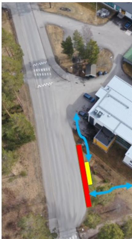
Kuva 57. Levennetty linja-autopysäkki tehdään ajoradasta erikseen Taitotalon viereen.
