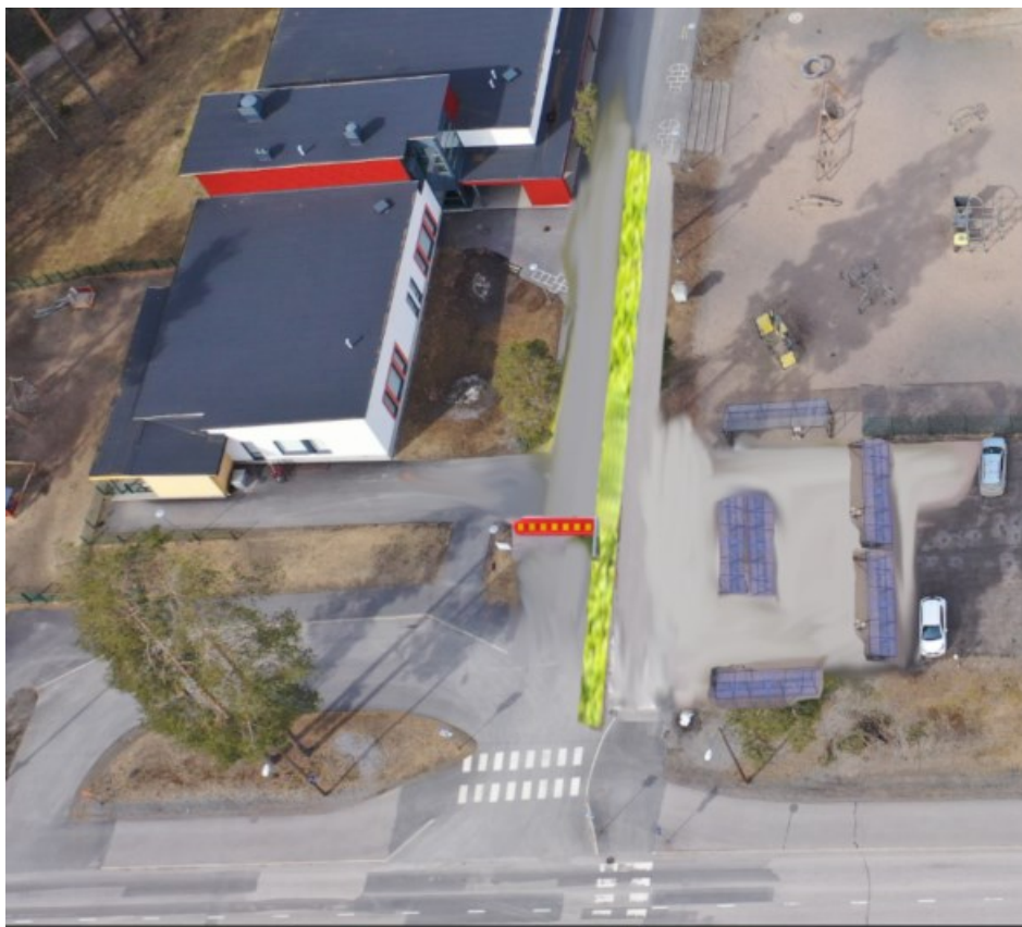
Kuva 52. Henkilökunnan pysäköintialueelle ajo estetään polkupyöräpysäköintikatoksilla, mitkä on muutoinkin alimitoitettu.
