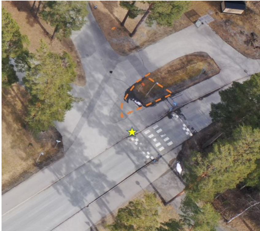
Kuva 55. Ajolinjat muutetaan lisäämällä kuvassa olevan tähden kohdalle heijastintolppa tai pollari, sekä katkoviivoin osoitetulle kohdalle kasvillisuutta.
