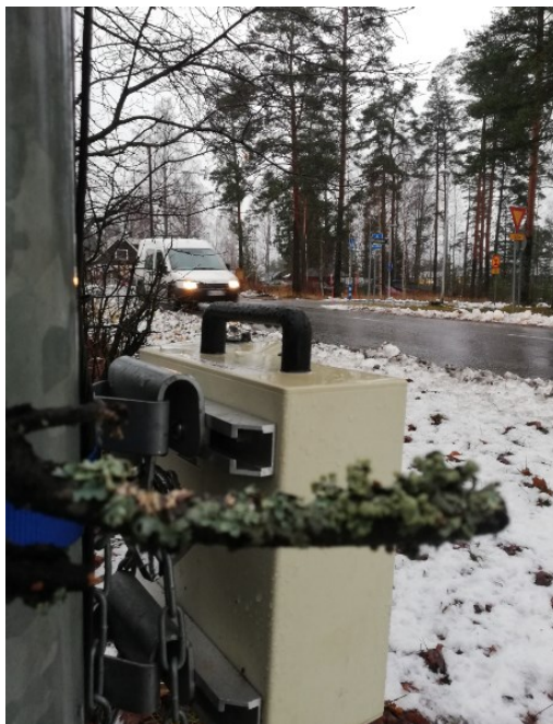
Kuva 12. Jousitien varrella oleva ViaCount2-liikennelaskimen tutkavarjo osoittaa ohjeiden mukaisesti 45 asteen kulmassa ajorataan nähden.
