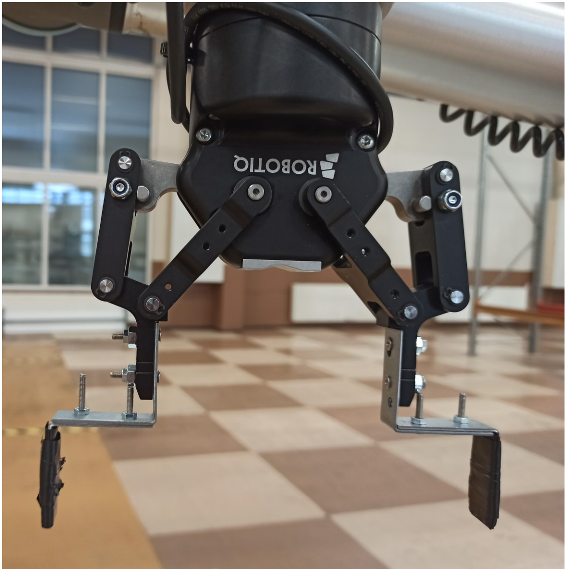
KUVA 2. Robotiq 2F-85 tarttuja ja siihen rakennettu lisäosa
