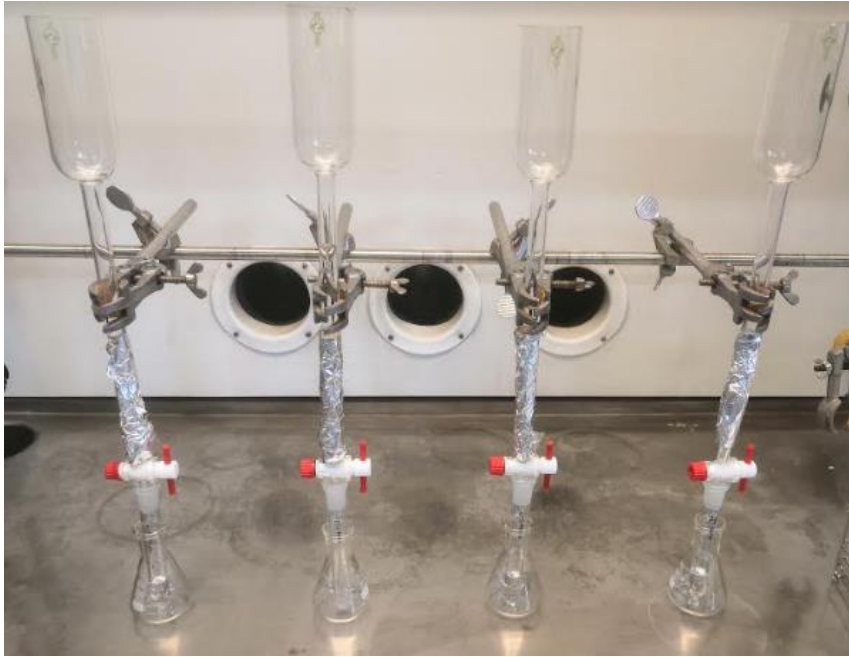
Kuva 13. Kiinteäfaasiuuttokolonnit MOSH- ja MOAH-fraktioiden erotteluun. Kolonnit on peitetty foliolla kohdasta, jossa stationäärifaasi sijaitsee, koska sen sisältämä hopeanitraatti hajoaa valon vaikutuksesta.
