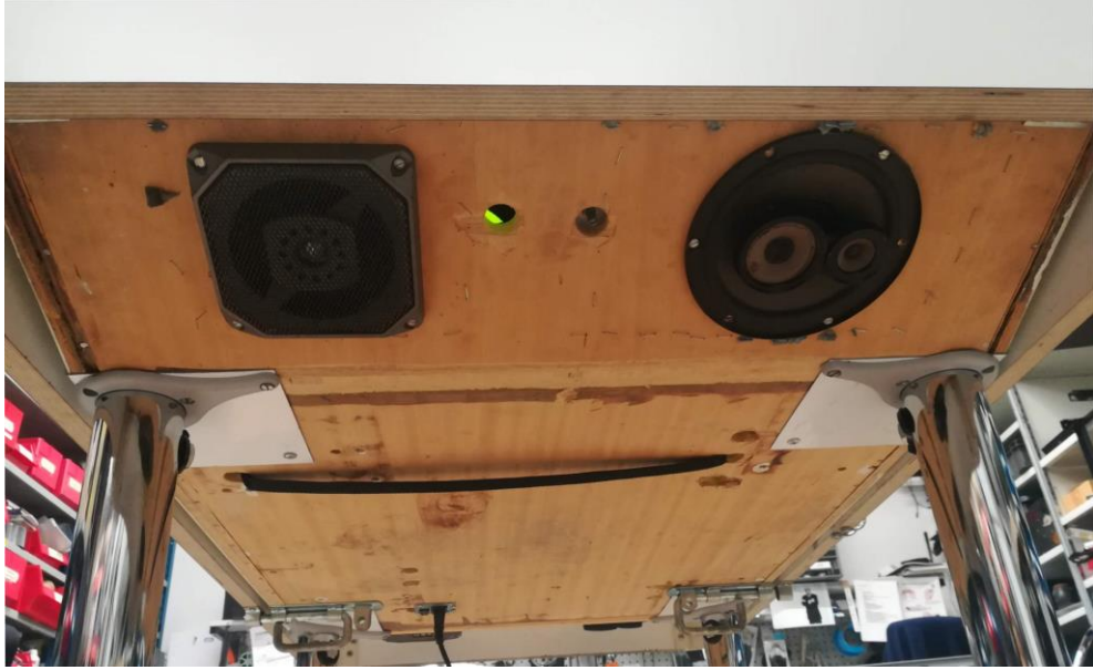
Kuva 44. Kaiutinpari on asennettu teoksen sisäpohjaan, suunnattuna ulos ja alaspäin
