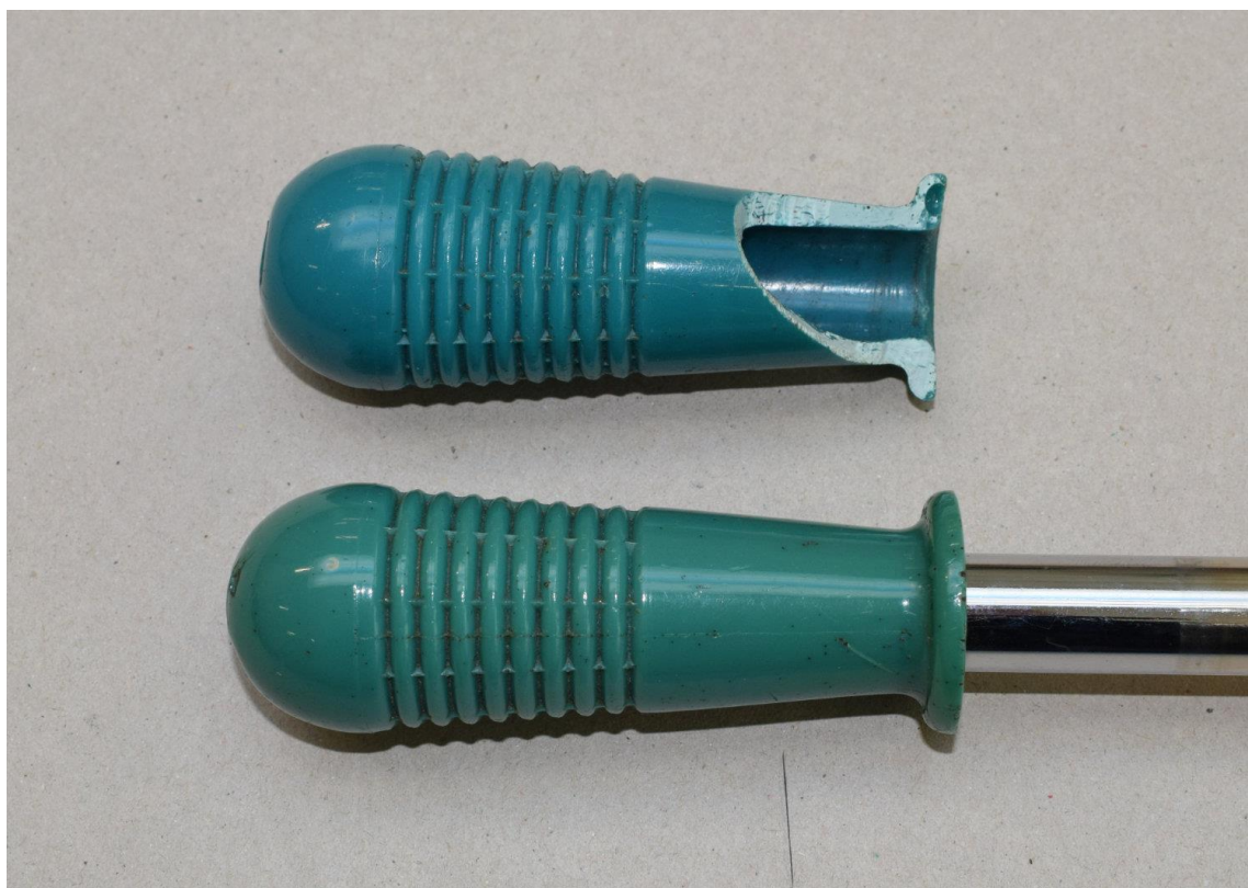
Kuva 31. Rikkonainen kahva säilytetty valolta suojattuna, ehjä kellastunut UV-säteilyn vaikutuksesta
