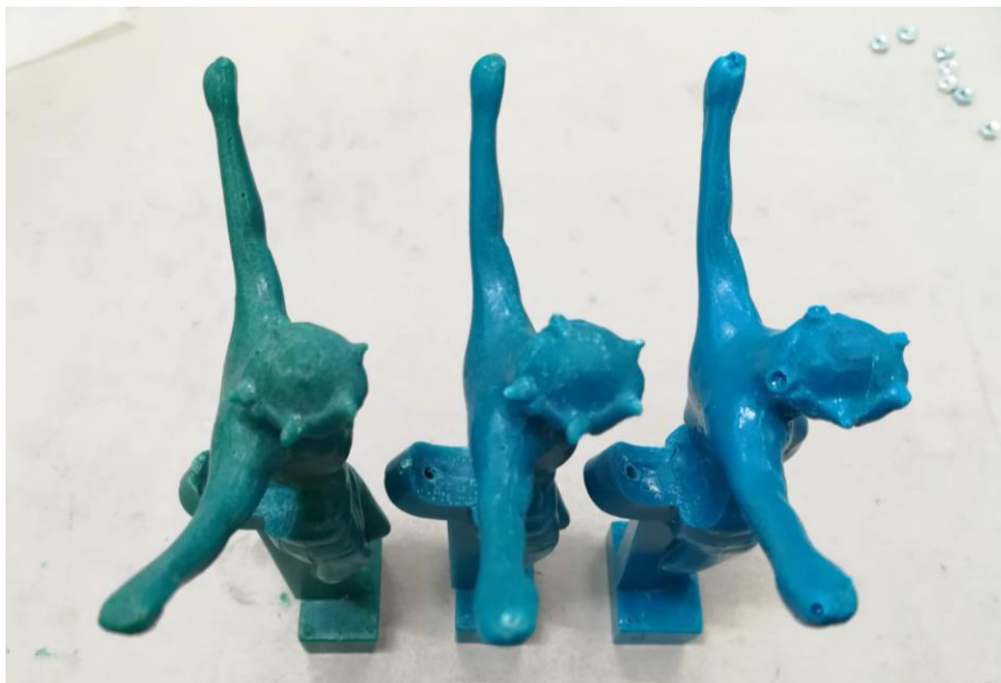
Kuva 26. Sinisen polyuretaanin värimuutos.
