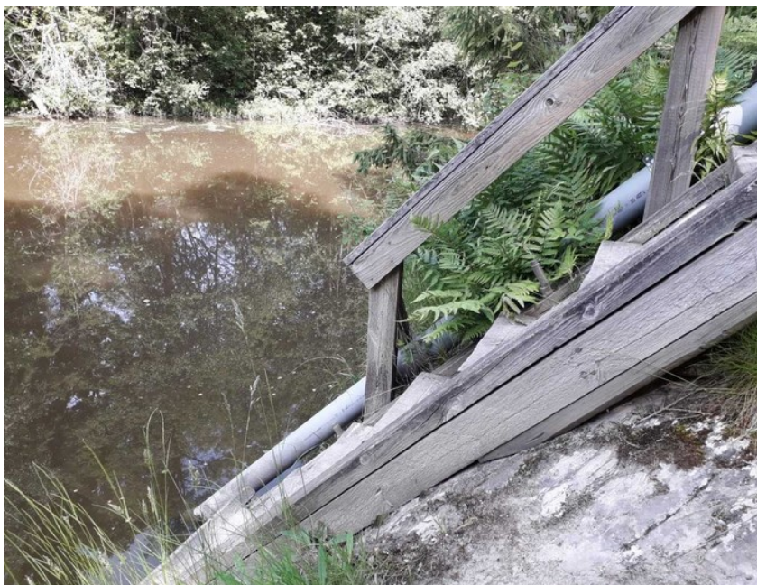
Kuva 7. EXO2-mittarin asennus Siuntionjoessa. Mittari on pääosin putken sisällä, mutta antureiden päät ovat putken ulkopuolella vedenpinnan alapuolella.
