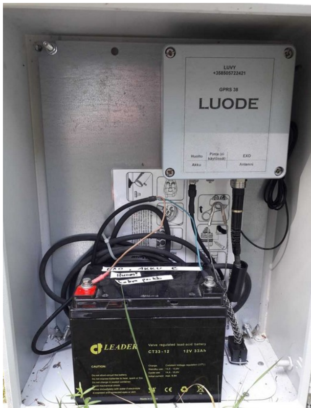
Kuva 8. EXO2 -mittarin datankeräin (ylhällä) sekä virtalähteenä toimiva 12 V:n akku (alhaalla).
