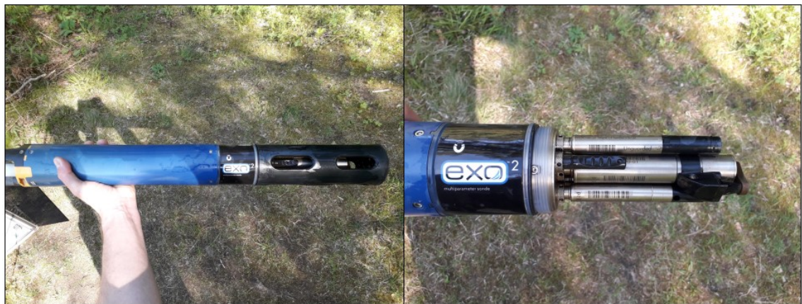
Kuva 1. EXO2 -sondi kokonaisuudessaan (vasemmalla) ja suojuksen alla sondiin kiinnitetyt anturit (oikealla).
