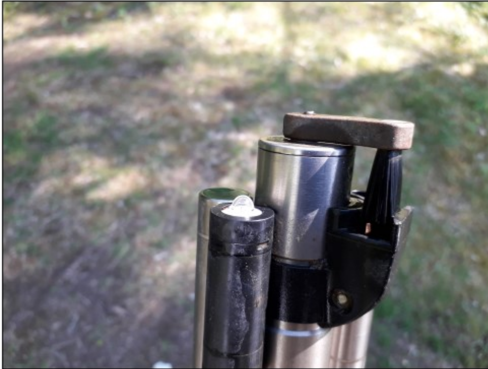
Kuva 2. EXO2 -mittarin puhdistuspyyhin (keskellä) ja anturit (reunoilla). Puhdistuspyyhin on mahdollista korvata lisäanturilla, mutta tämä yleensä lyhentää huoltoväliä.
