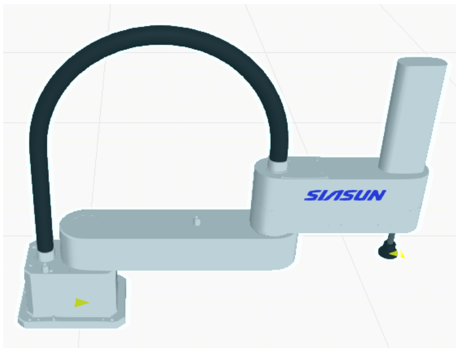
KUVA 2. SCARA robotti (Visual Components 2020)
