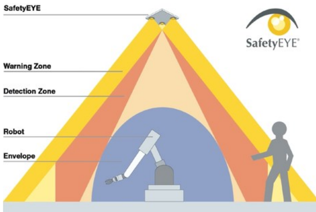
KUVA 5. SafetyEYE:n muodostama valvontakartio poikkileikkauksena. (Iversen 2007)
