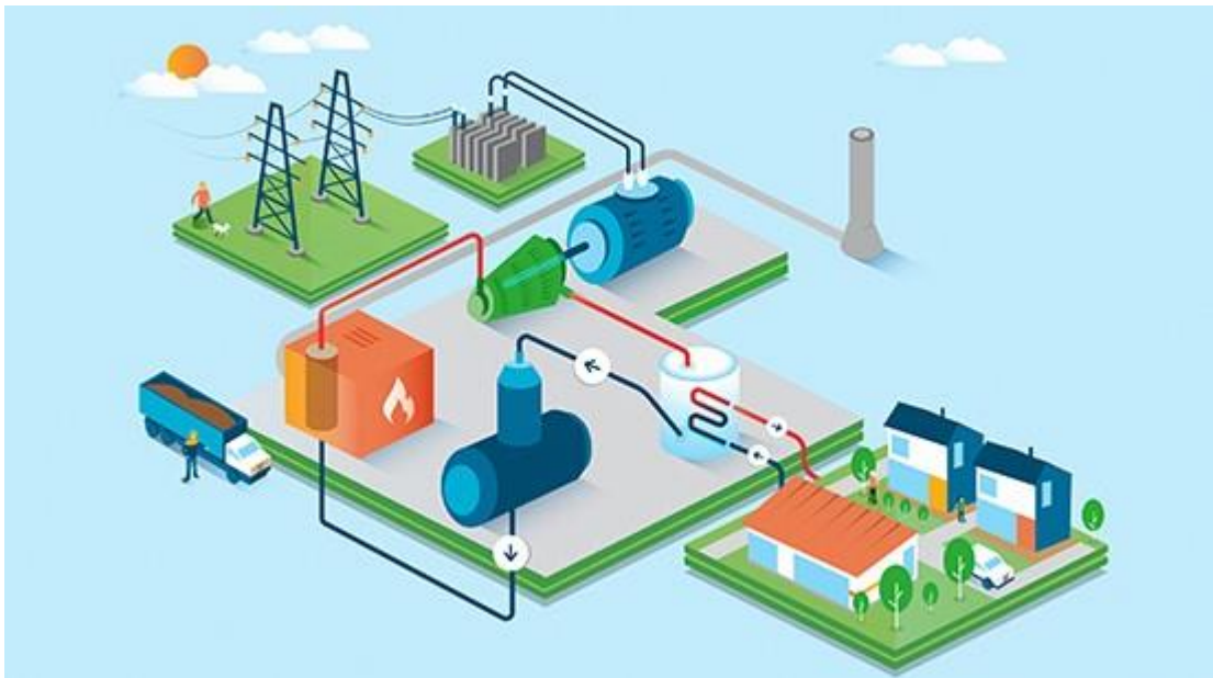
Kuva 2. Kaukolämpöveden matka voimalaitokselta kiinteistöjen lämmönjakokeskuksiin [Ryynänen].
