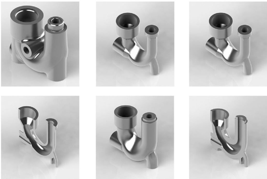
Kuva 7.3. Putkimutkan suunnittelukuvat: lähtötilanne, kevennetty ja lopullinen.
