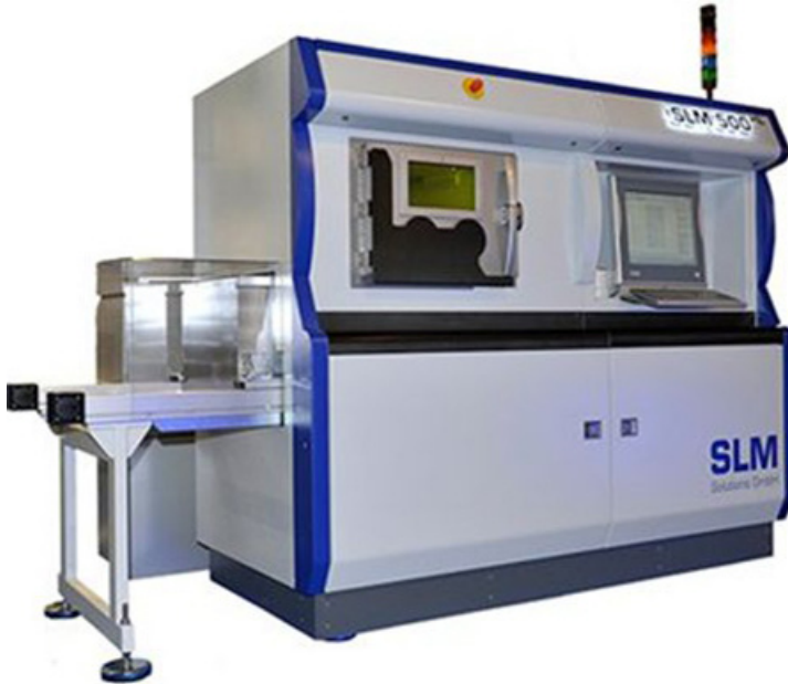
Kuva 3.4. SLM-500, tulostusalueeltaan suurin SLM Solutions GbmH:n myymä järjestelmä. (Lähde: SLM Solutions GmbH)
