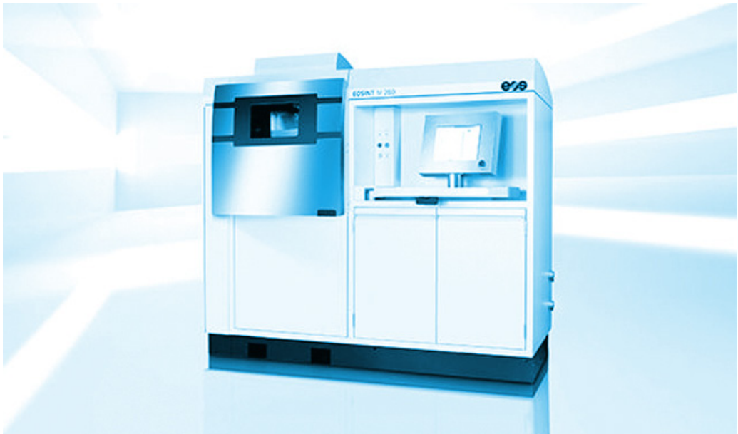
Kuva 3.2. EOS M280 on uusin versio EOSin yleisimmästä jauhepetitekniikkaan pohjautuvasta tulostimesta. (Lähde: EOS)
