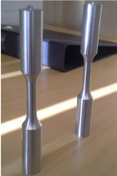
Kuva 5.10. Vertailumateriaalista valmistetut testisauvat.
