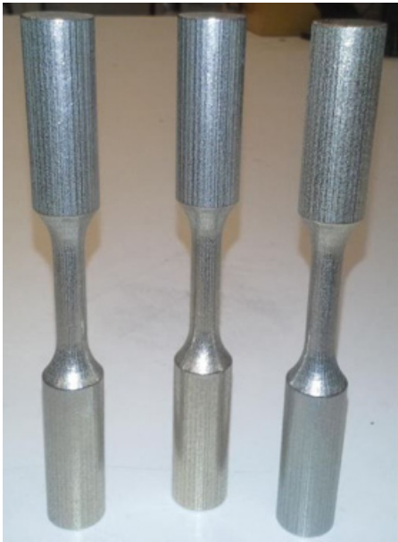
Kuva 5.11. SS420 + pronssi –materiaalista valmistetut testisauvat.
