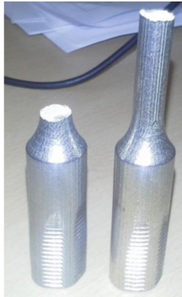
Kuva 5.11. SS420 + pronssi –materiaalista valmistetut testisauvat.
