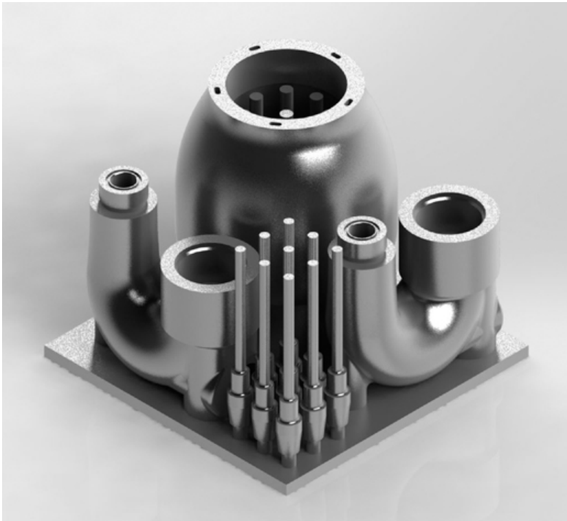
Kuva 3.3. Esimerkki kappaleiden asemoinnista tulostusalustalle.
