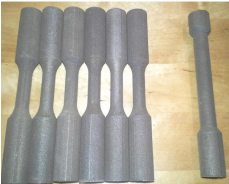
Kuva 5.12. DMLS 316 L –materiaalista valmistetut testisauvat koneistusvaralla.
