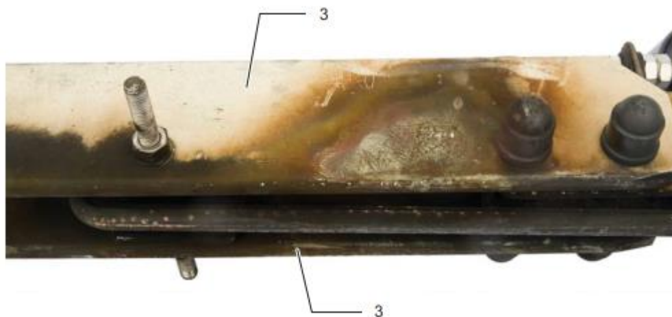
Kuva 16. Esimerkkikuva jaksoerotin eristysosasta, missä on hiilikertymä. (Siemens, Section Insulator Sicat 8WL5570-1AF, Operating Instructions 2012.)
