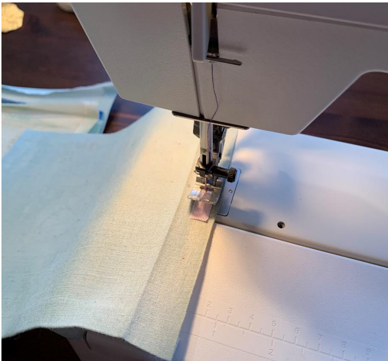
Kuva 4. Tarranauhakiinnityksen ompelu taskun suuhun.
