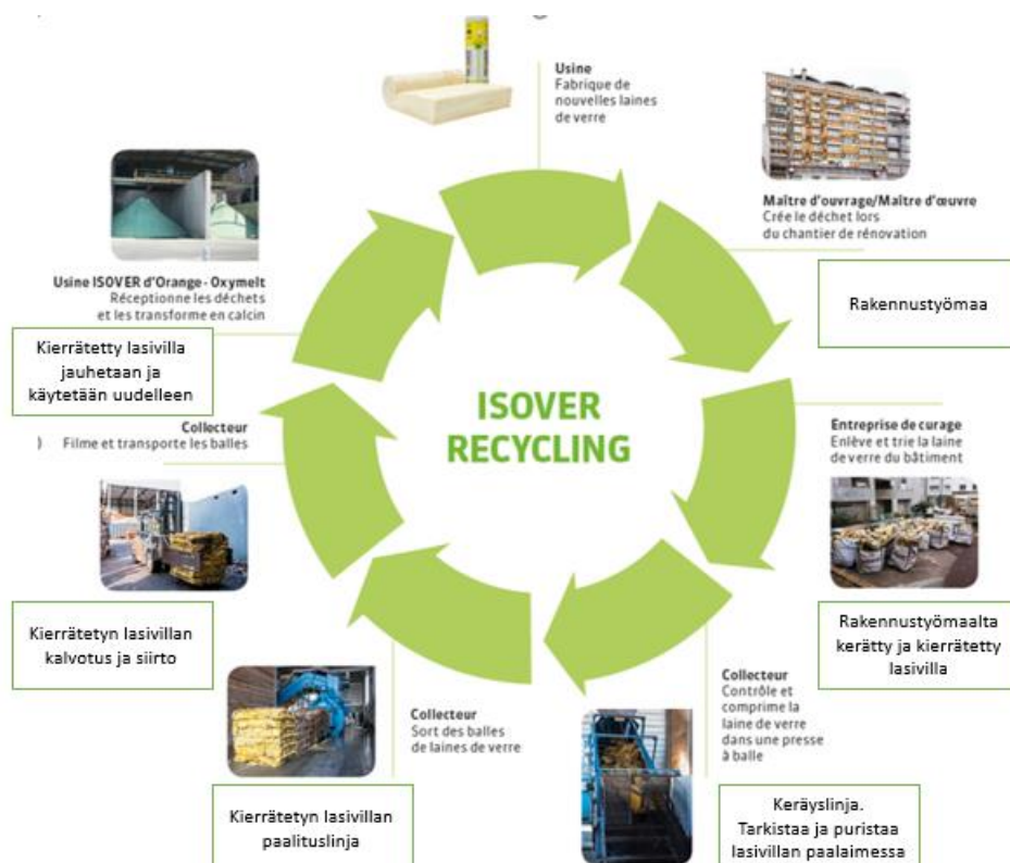
Kuva 11. Lasivillan kierrätyksen periaate (Isover recycling 2018)
