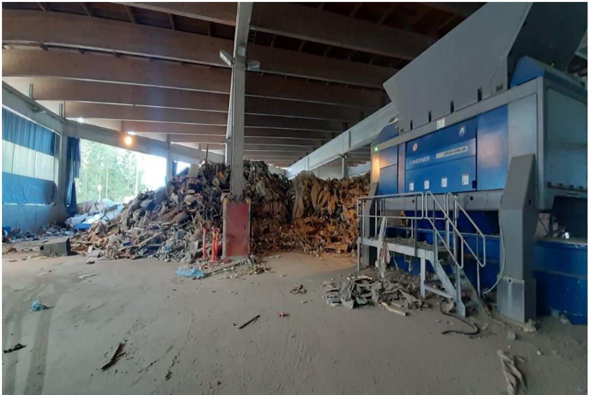
Kuva 17. Läjitysapaikka, jossa jätteet lajitellaan manuaalisesti. Näin ei vaaralliset ja jätteet ja isot metallit päädy kuljettimelle
