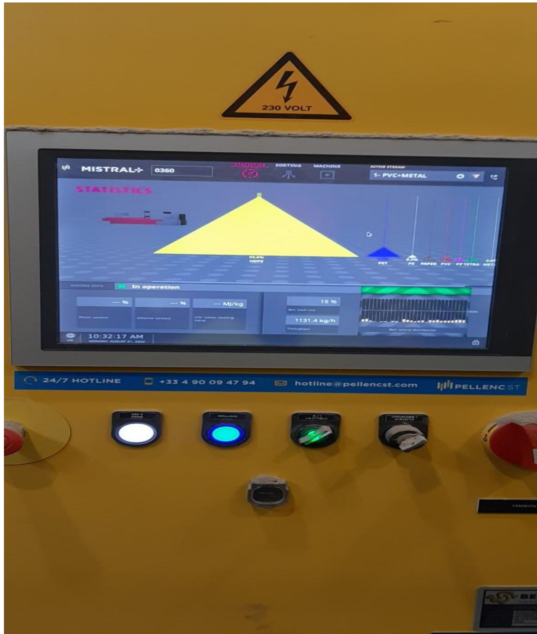
Kuva 20. Lajittelukoneen NIR-ohjausyksikkö, jossa jätteet tunnistetaan infrapuna- nalla ja halutut materiaalit kuten PVC erotetaan paineilmalla muusta virrasta
